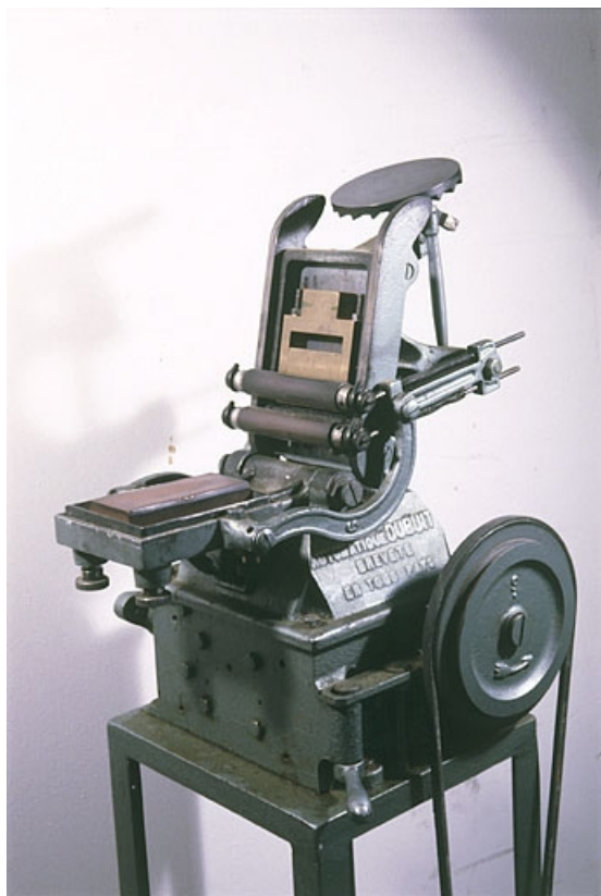
De gauche à droite : platine, rouleaux encreurs, marbre et table d'encrage (soleil). 39, Saint-Claude, 12 rue de la Poyat
