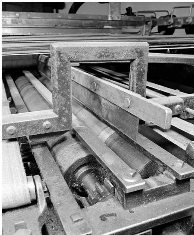
Détail d'un étage de pliage. La feuille est pliée lorsque le bras horizontal (au centre) la fait passer entre les deux rouleaux. 39, Saint-Claude, 12 rue de la Poyat
