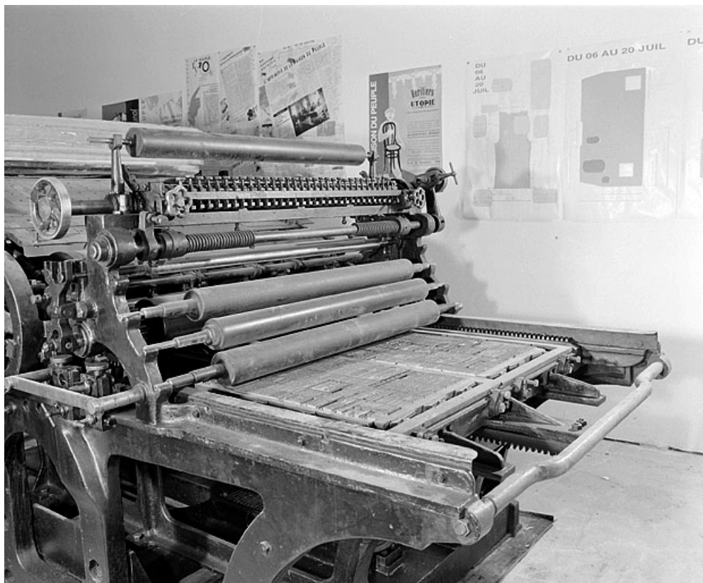
Partie avant de la machine. Système d'encre vertical (encrier et rouleaux encres) à gauche, marbre portant une forme et sa composition à droite.
