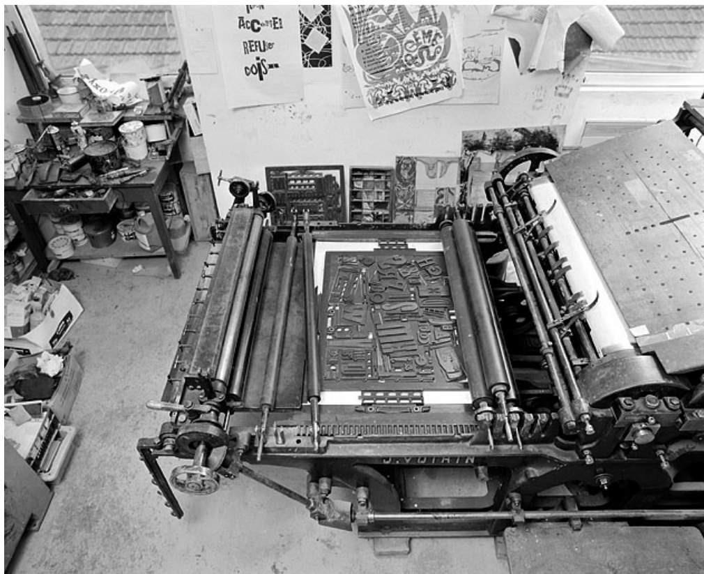
De gauche à droite : système d'encre (encrrier, table d'encre et rouleaux encres), marbre portant une forme et sa composition, cylindre et table de marge.
