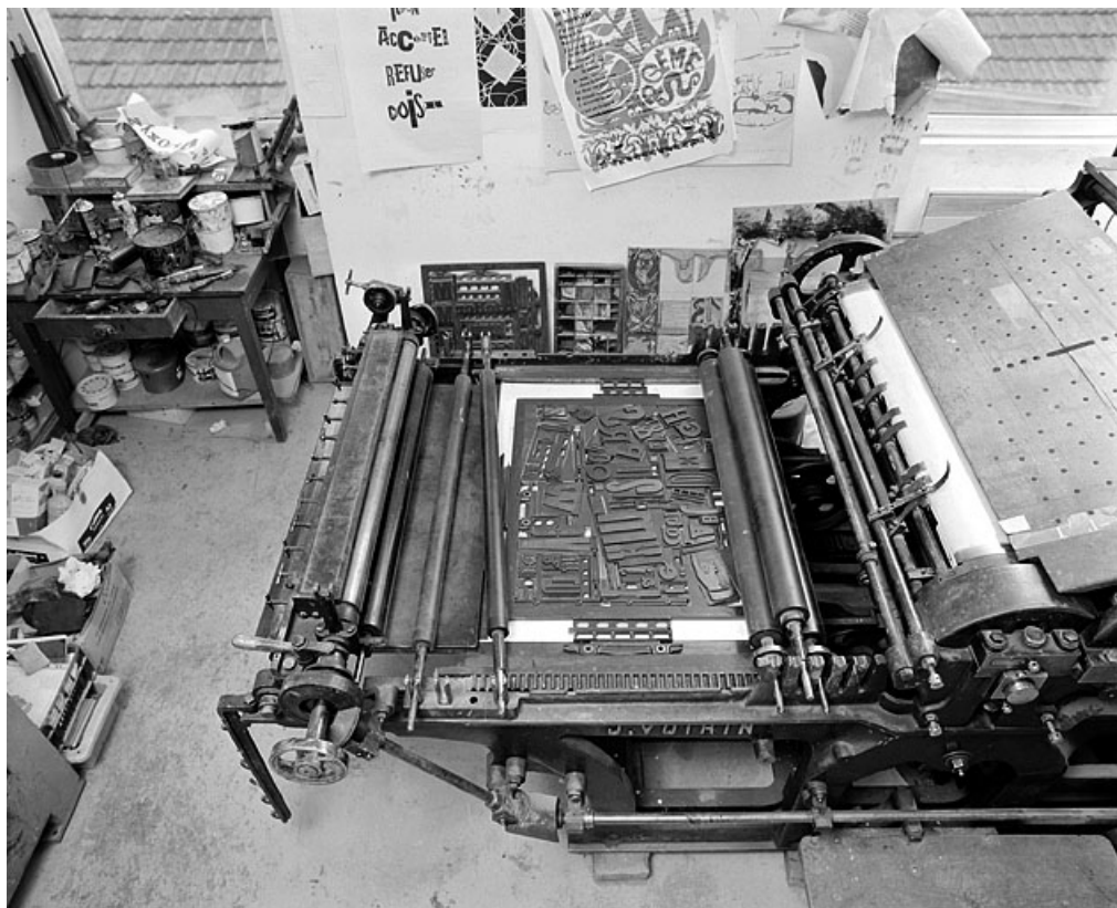
De gauche à droite : système d'encre (encrier, table d'encre et rouleaux encres), marbre portant une forme et sa composition, cylindre et table de marge.
