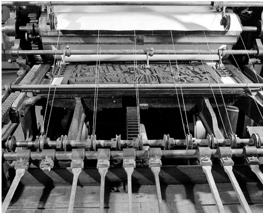
Partie arrière de la machine, vue de face. Les fils permettent de soutenir la feuille qui sera déposée sur la table de réception, à droite, à l'aide du receveur mécanique à raquettes.
