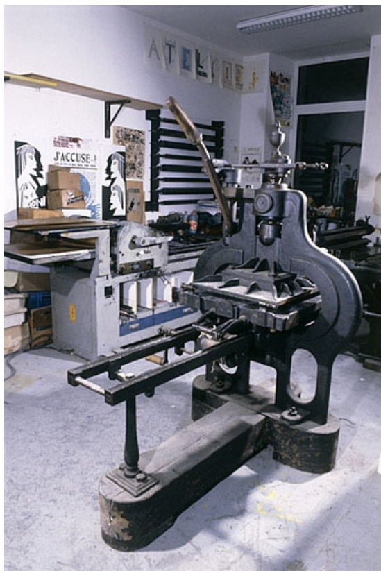
Vue d'ensemble de trois quarts droite, marbre (chariot) sous la platine.
