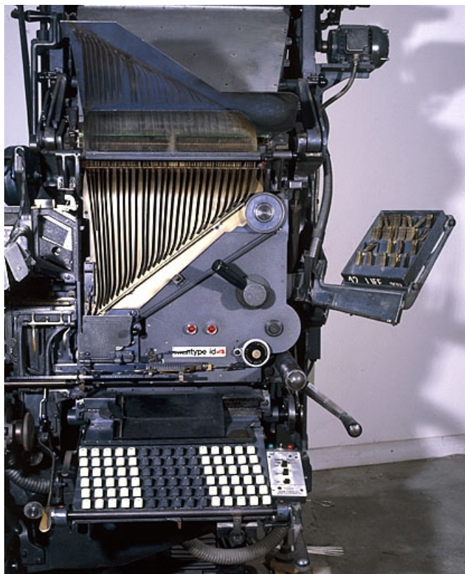
Détail du clavier et des canaux conduisant les matrices du magasin au composteur.
