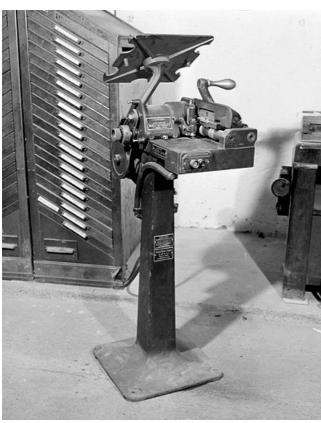
Vue d'ensemble d'une machine. Le support des lignes-blocs ("lutrin") est monté à l'envers (inclinaison vers l'arrière et non vers l'avant).
