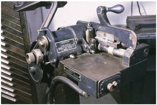
Détail : systèmes d'entraînement de la fraise et de fixation de la ligne-bloc. Une ligne-bloc est serrée dans la machoire. 39, Saint-Claude, 12 rue de la Poyat
