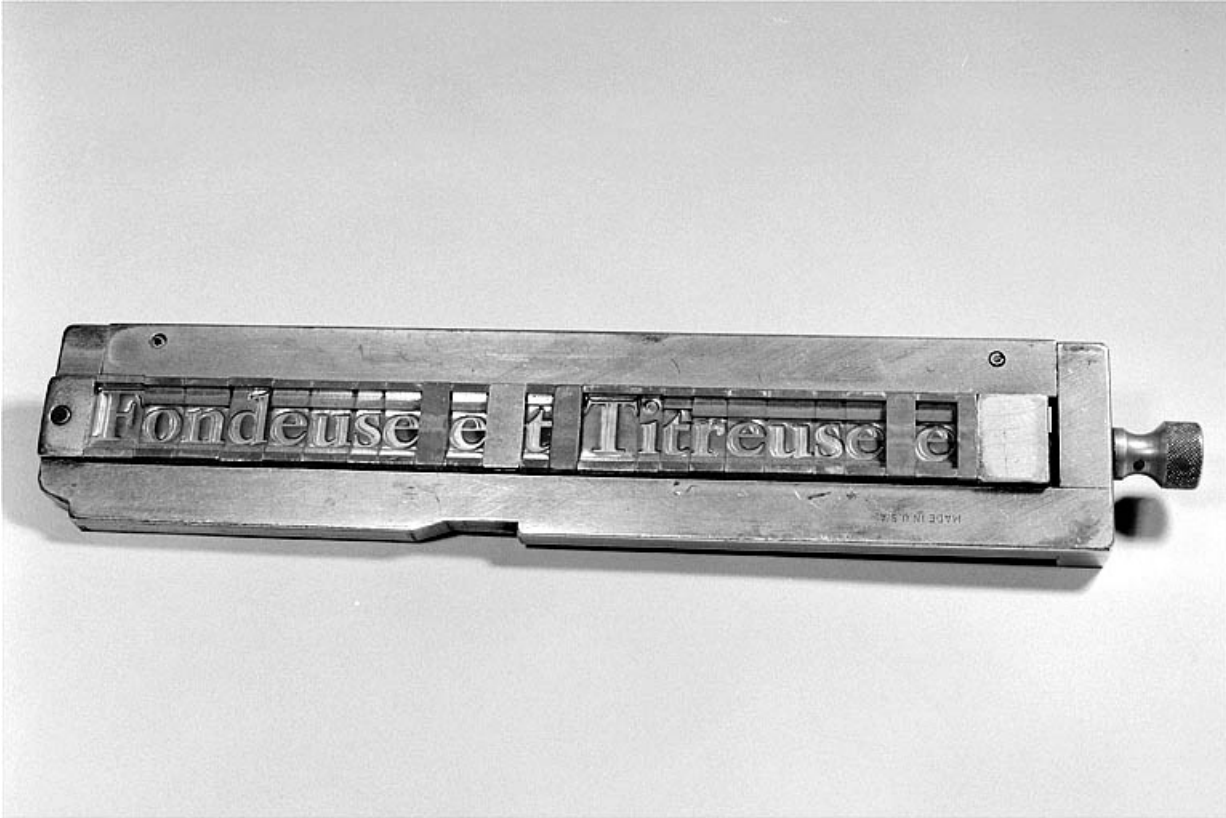
Face inférieure d'un compositeur, matrices de caractères en place. Le caractère apparaît en négatif dans chaque matrice. 39, Saint-Claude, 12 rue de la Poyat
