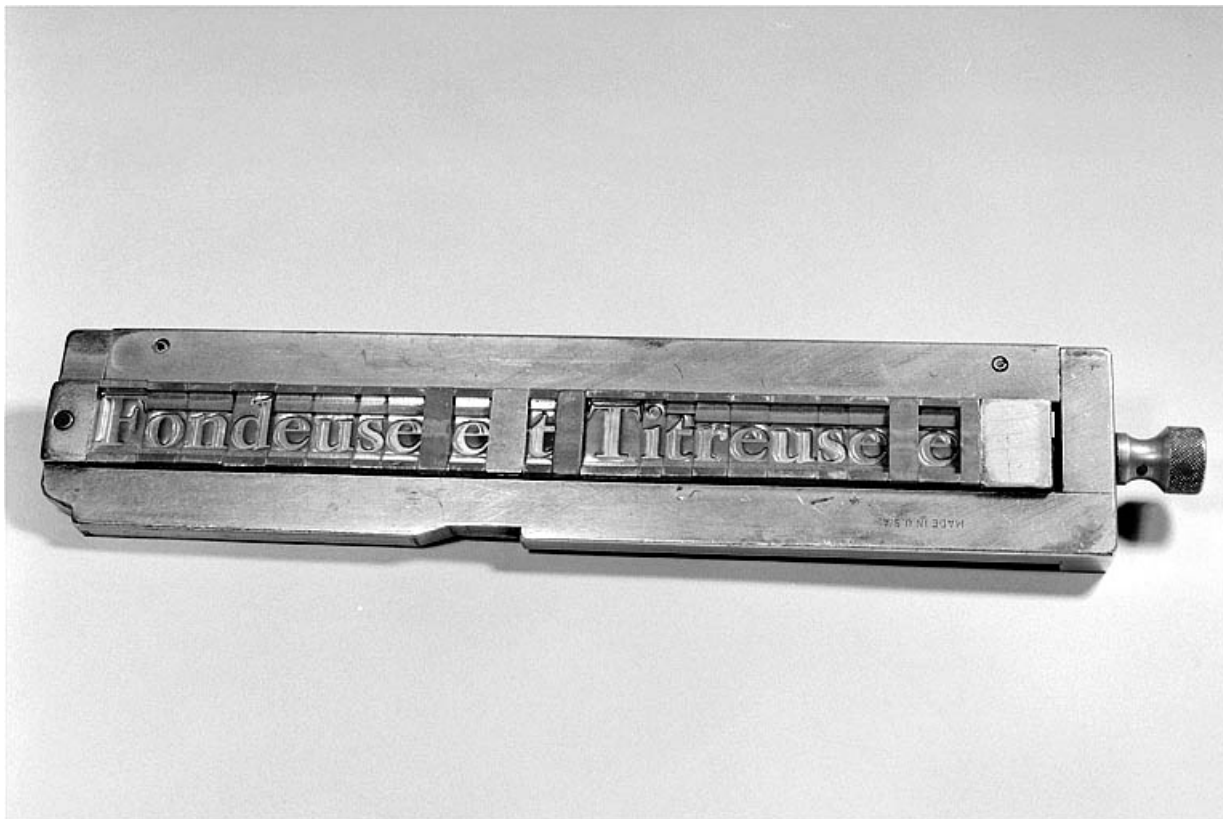
Face inférieure d'un composeur, matrices de caractères en place. Le caractère apparaît en négatif dans chaque matrice. 39, Saint-Claude, 12 rue de la Poyat
