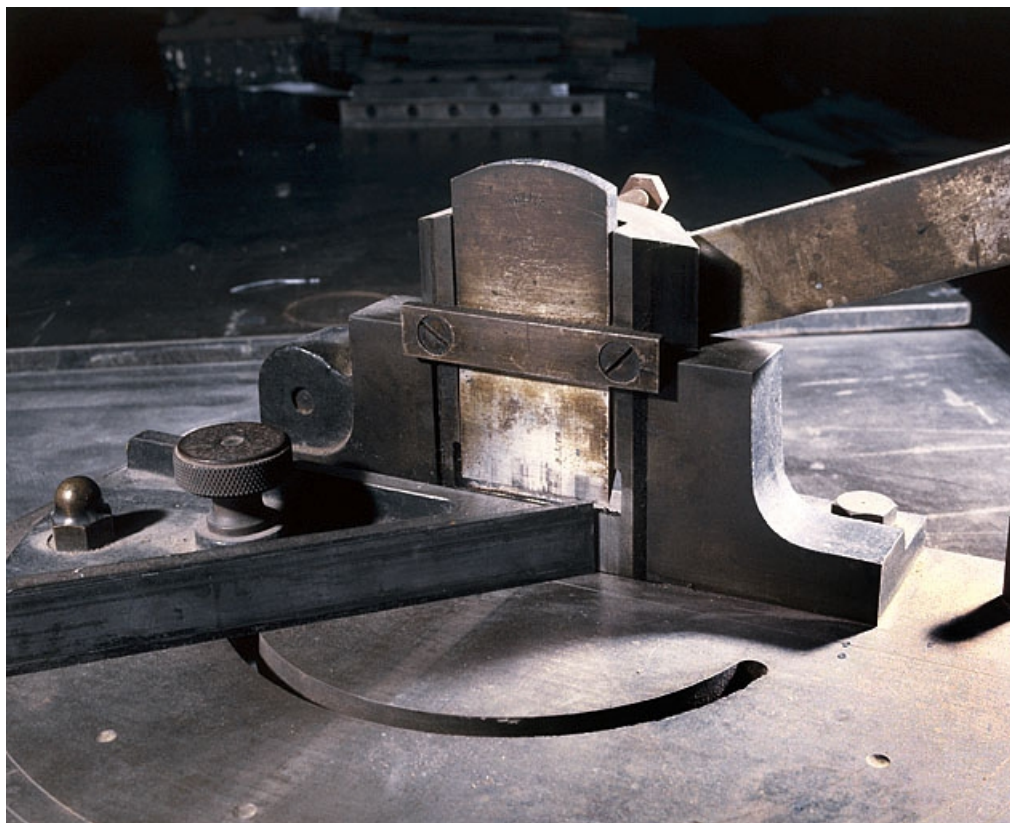
Coupe oblique d'un filet avec le "coupeur-rabot". Le filet est appuyé contre le guide triangulaire mobile, à gauche.
