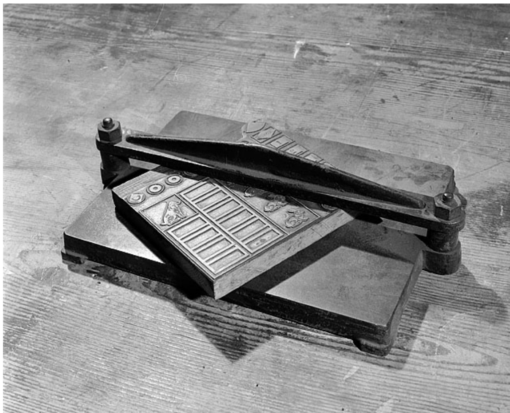
Vue d'ensemble : vérification de la hauteur typographique d'un cliché.
