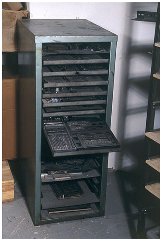
Meuble à galées à une travée. Les galées portent des lignes de texte et d'autres compositions.
