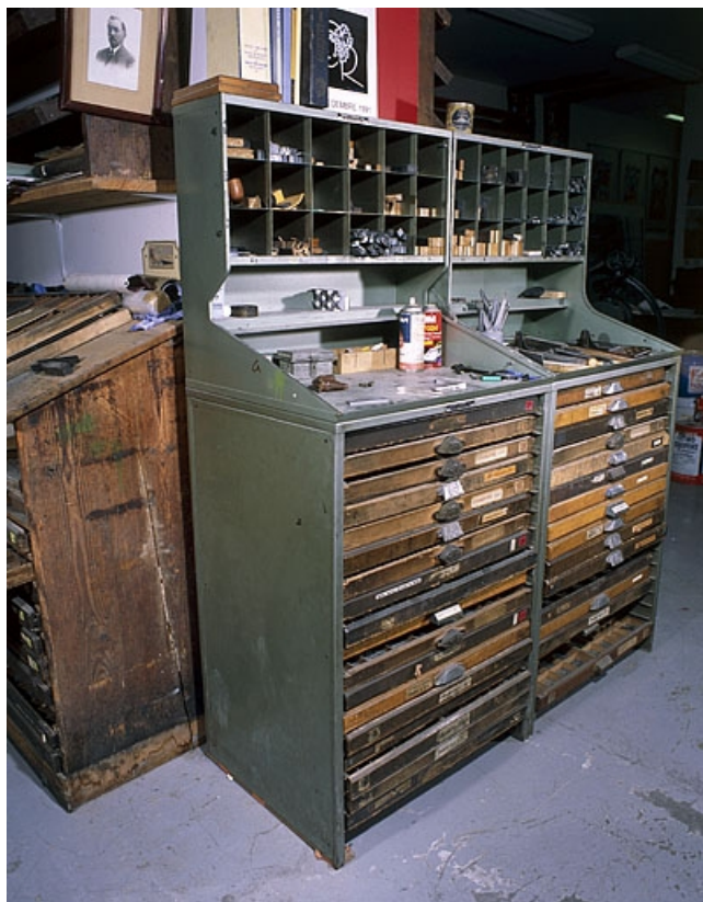
Deux rangs à pupitre et lingotiers. Ici composé d'une tôle formant un plan de travail incliné, le pupitre a été ôté. 39, Saint-Claude, 12 rue de la Poyat
