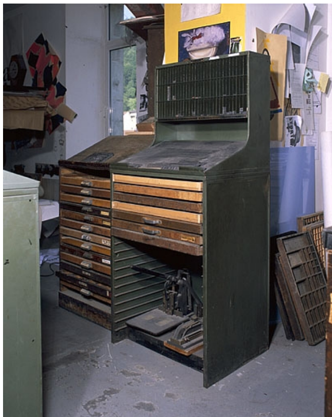
Rang à pupitre et interlignier. Ici composé d'une tôle formant un plan de travail incliné, le pupitre est en place. 39, Saint-Claude, 12 rue de la Poyat
