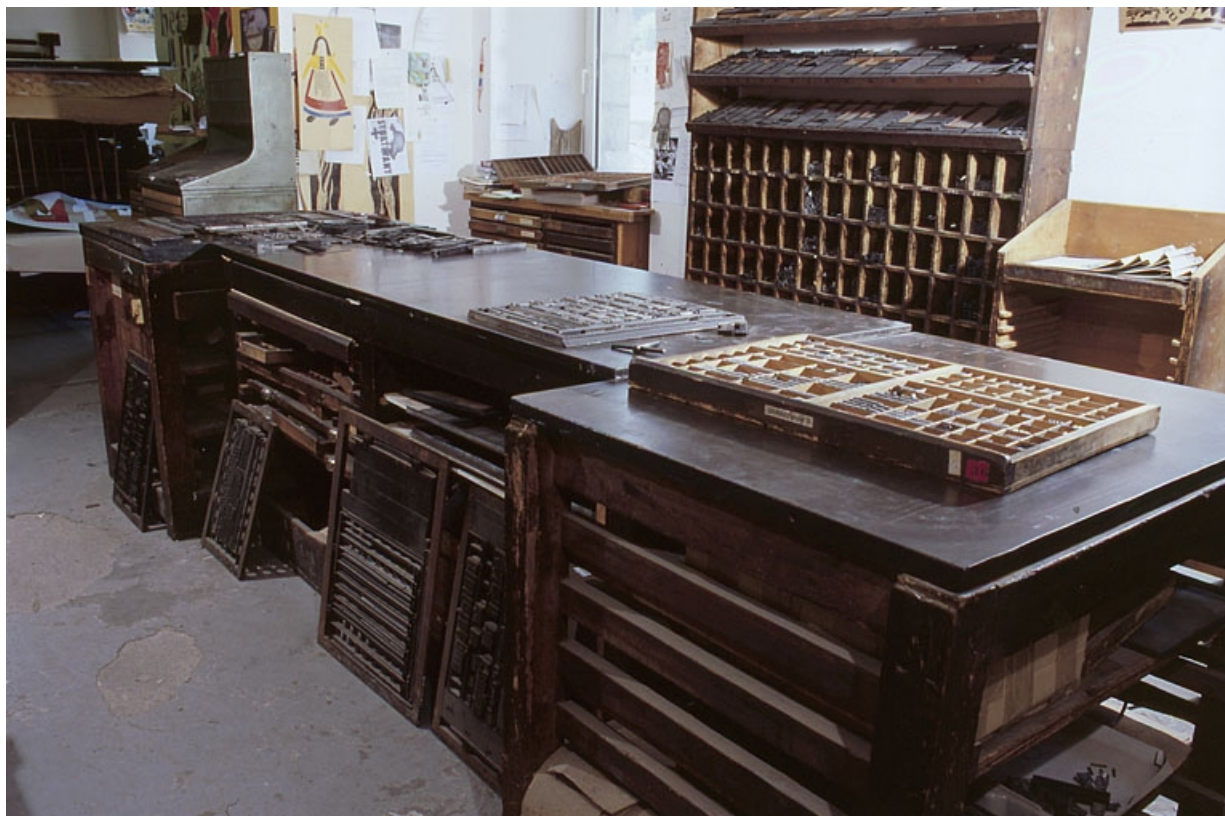
Vue d'ensemble. Casse parisienne au premier plan sur le marbre, forme d'imprimeur avec sa clé de serrage au second plan.
