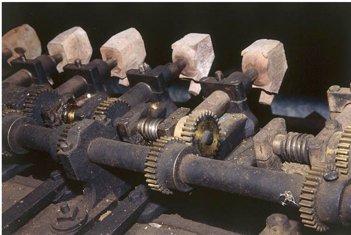
Face arrière : engrenages permettant la rotation simultanée des ébauchons.
