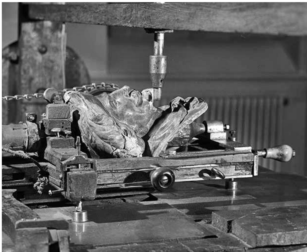
Modèle (d'Artagnan) et son support mobile, vus de trois quarts arrière gauche. Manœuvré à l'aide de poignées, le support glisse sur une plaque métallique, chaque détail du modèle pouvant ainsi être retransmis par le palpeur vertical.
