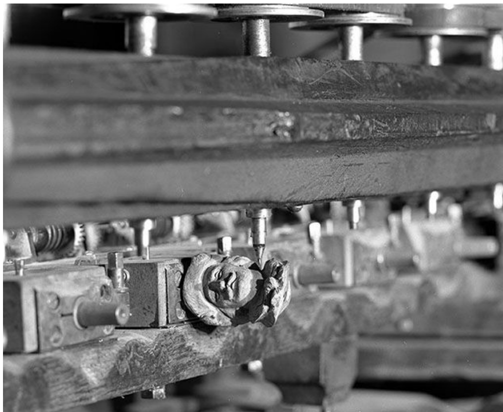
Face arrière : ébauchon sculpté et fraise de finition.
