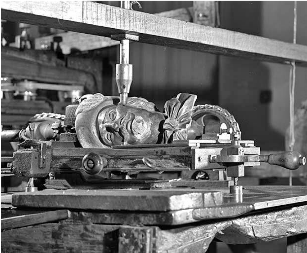
Modèle (d'Artagnan) et son support mobile, vus de trois quarts avant gauche. Manœuvré à l'aide des poignées, le support glisse sur une plaque métallique, chaque détail du modèle pouvant ainsi être retransmis par le palpeur vertical.
