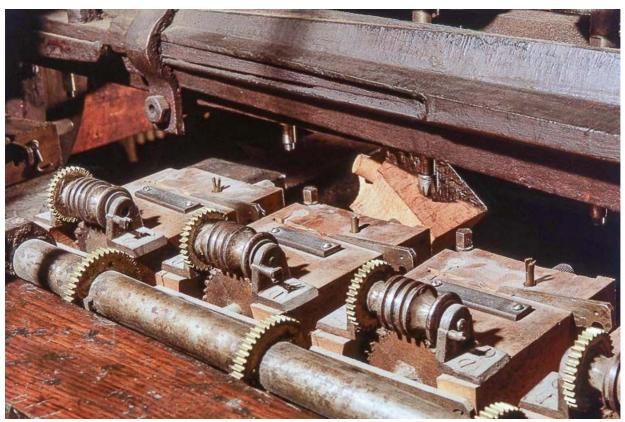
Face arrière : engrenages permettant la rotation simultanée des ébauchons (vue rapprochée). 39, Saint-Claude, 19 rue Carnot
