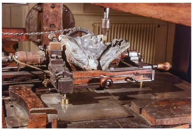
Modèle (d'Artagnan) et son support mobile, vus de trois quarts arrière gauche. Manoeuvré à l'aide de poignées, le support glisse sur une plaque métallique, chaque détail du modèle pouvant ainsi être retransmis par le palpeur vertical.
