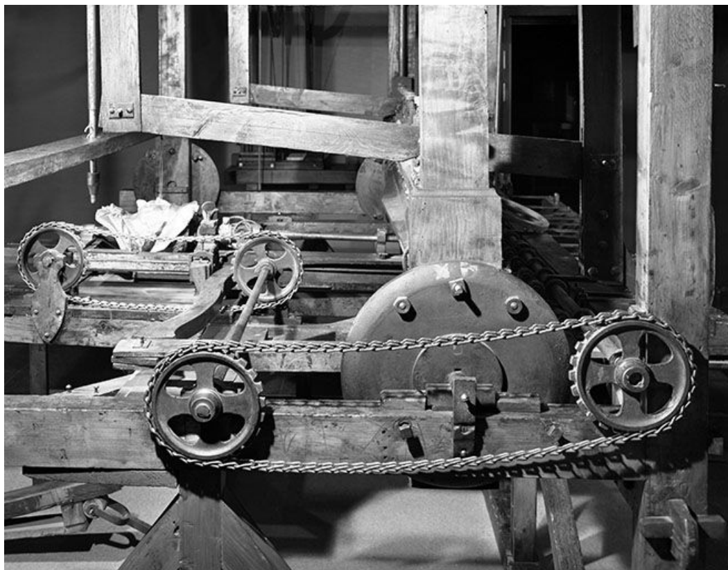
Face latérale droite. Aux premier et second plans, système de renvoi par chaîne permettant la rotation simultanée du modèle et des ébauchons.
