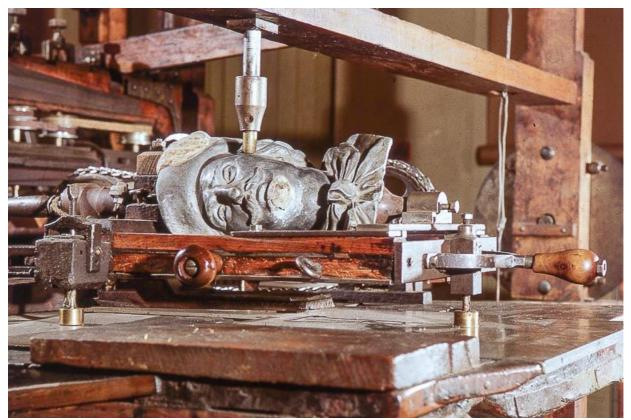
Modèle (d'Artagnan) et son support mobile, vus de trois quarts avant gauche. Manoeuvré à l'aide des poignées, le support glisse sur une plaque métallique, chaque détail du modèle pouvant ainsi être retransmis par le palpeur vertical.
