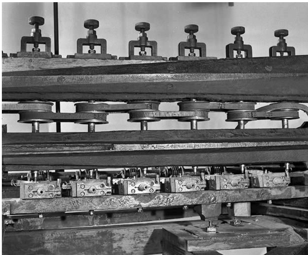
Face arrière : système moteur des fraises et supports des ébauchons. Le mouvement est transmis aux fraises à l'aide des poulies et des courroies en partie supérieure. Les ébauchons sont emboîtés dans les mandrins coniques en partie basse.
