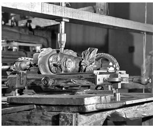
Modèle (d'Artagnan) et son support mobile, vus de trois quarts avant gauche. Manoeuvré à l'aide des poignées, le support glisse sur une plaque métallique, chaque détail du modèle pouvant ainsi être retransmis par le palpeur vertical.
