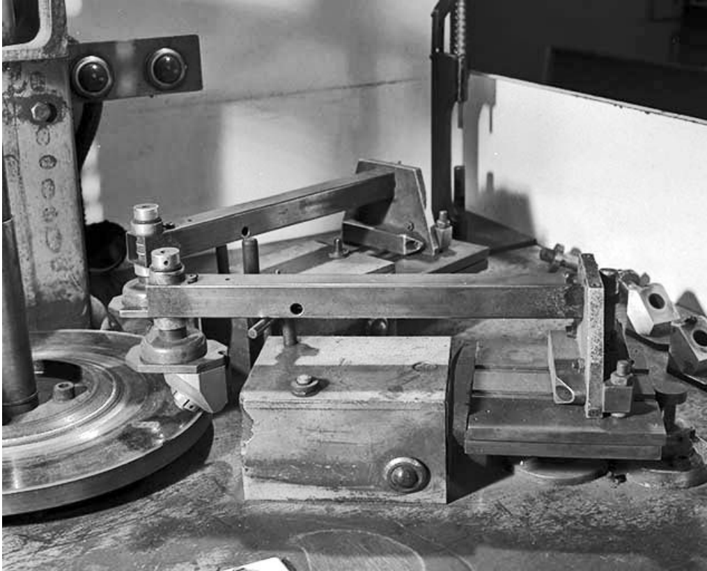
Pince mécanique (tenaille de lapidaire). La pince repose sur un boîtier qui va l'animer d'un mouvement de va-et-vient. 39, Saint-Claude
