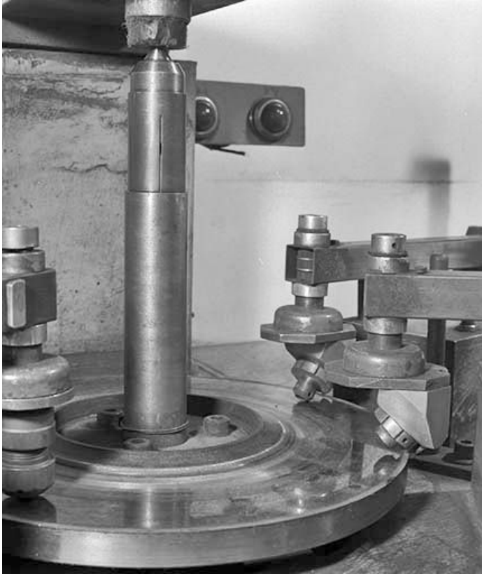
Tête des pinces mécaniques (tenailles de lapidaire) et meule. 39, Saint-Claude
