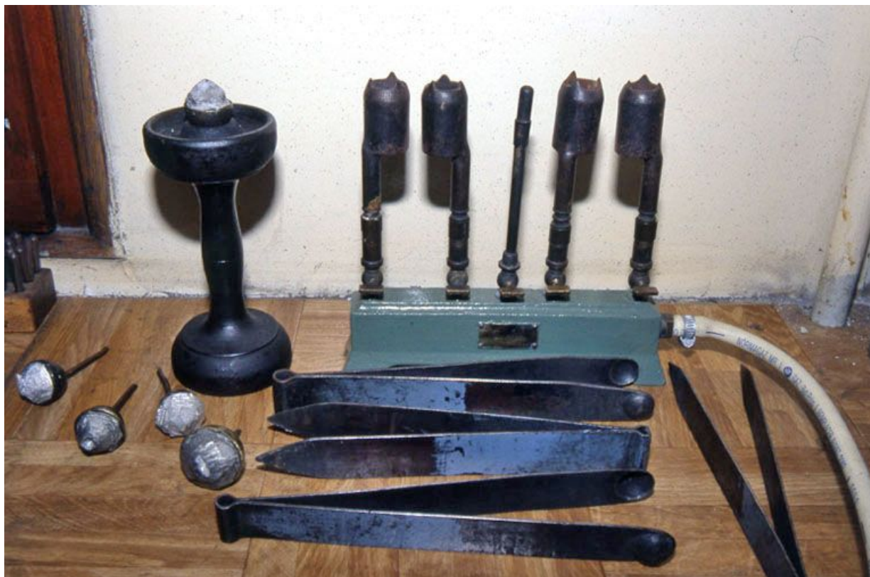
Bec de gaz, pinces, coquilles (dops) et leur support.
