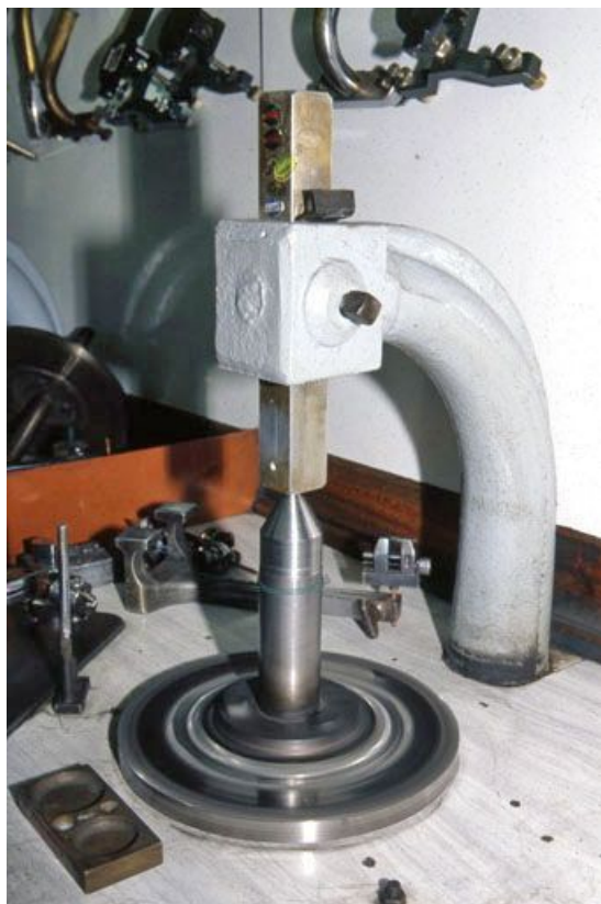
Meule et son système de fixation.
