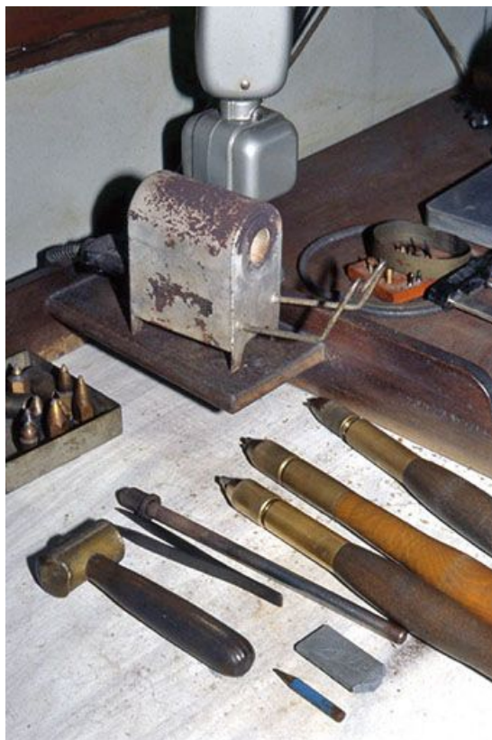
Four à résistance Portius. De gauche à droite, marteau pour désaxer la poupée fixe du tour, pince pour tenir le diamant, bâtons destinés à porter le second diamant. En haut à gauche, mandrins pour la fixation du diamant sur le tour. 39, Saint-Claude
