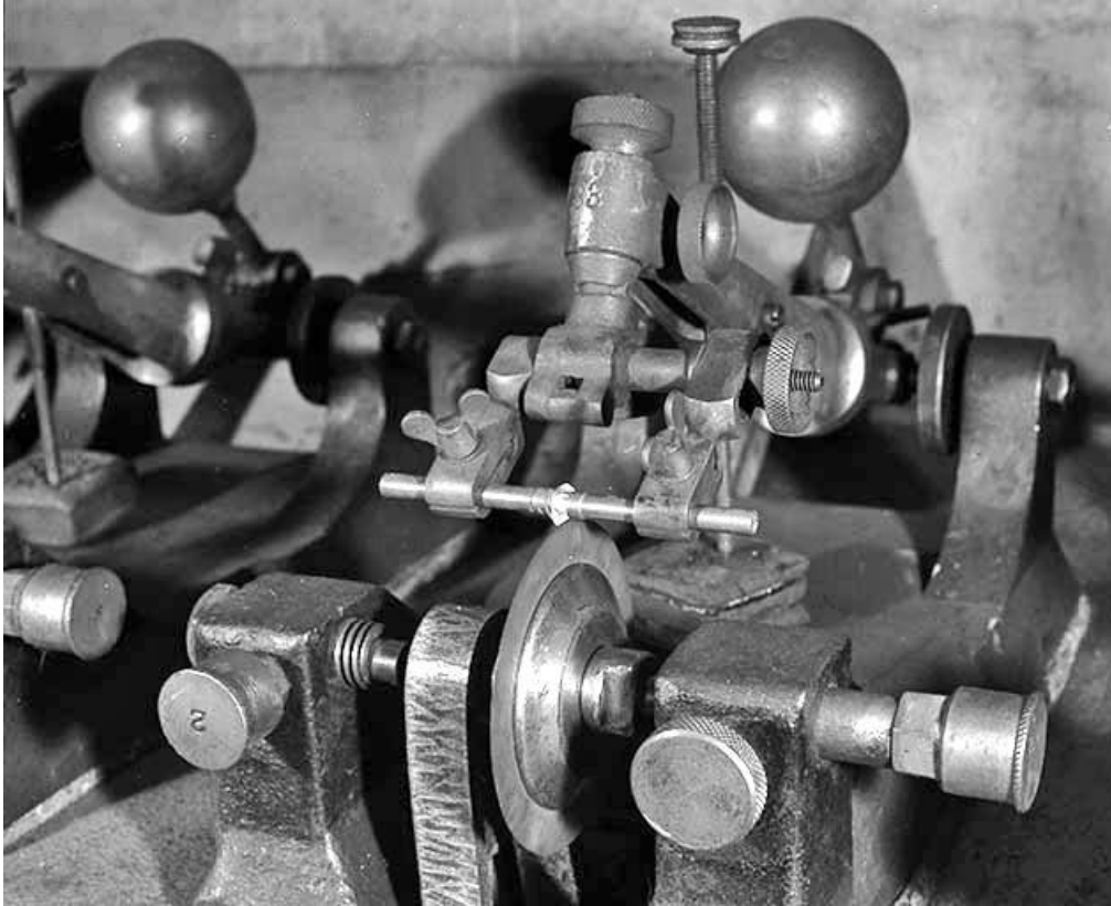
Scie vue de trois quarts. Pris entre deux mors, le diamant est au contact du disque en bronze phosphoreux. 39, Saint-Claude
