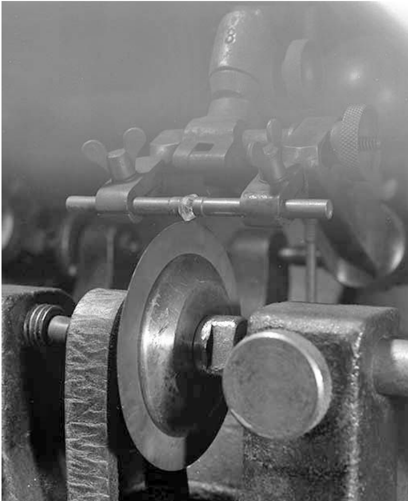
Molette (lame) d'une scie et diamant, vus de trois quarts. Pris entre deux mors, le diamant est au contact du disque en bronze phosphoreux.
