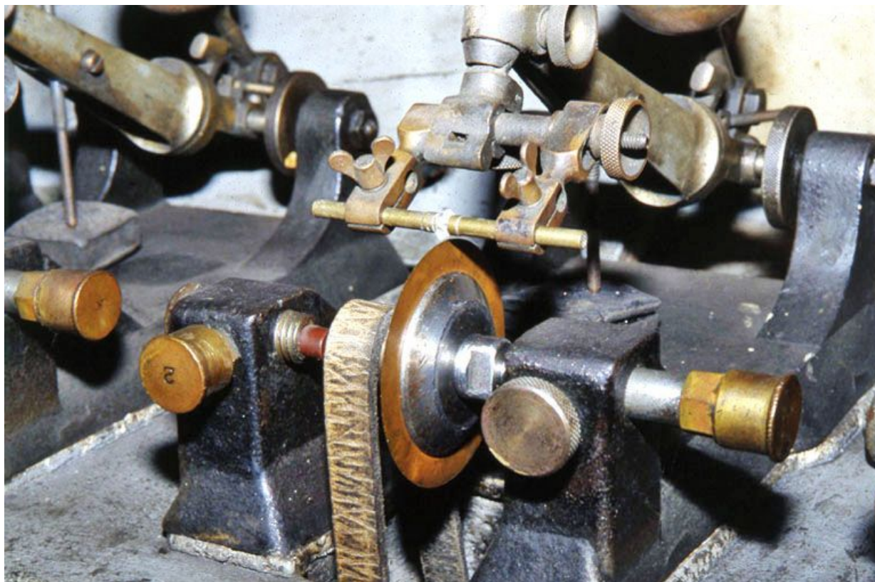
Scie vue de trois quarts. Pris entre deux mors, le diamant est au contact du disque en bronze phosphoreux. 39, Saint-Claude
