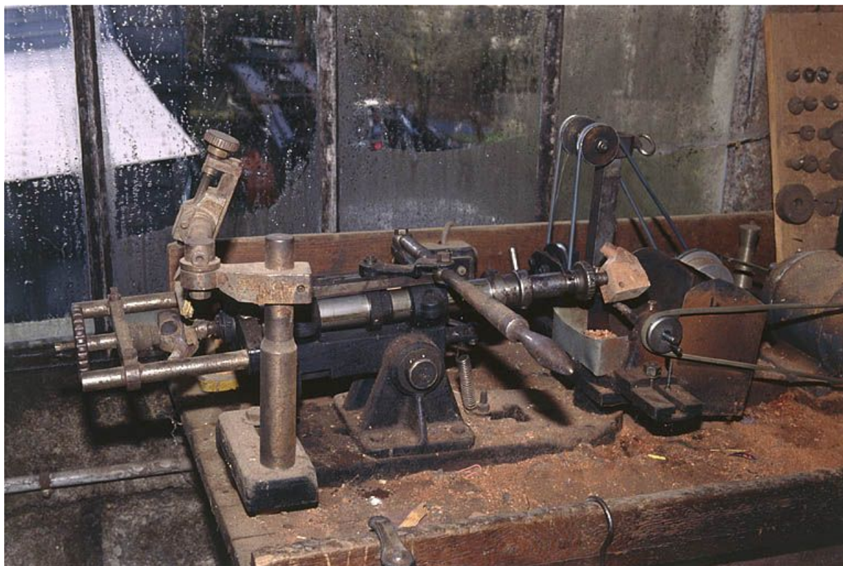
Vue d'ensemble de la partie gauche : guide et support de l'ébauchon.
