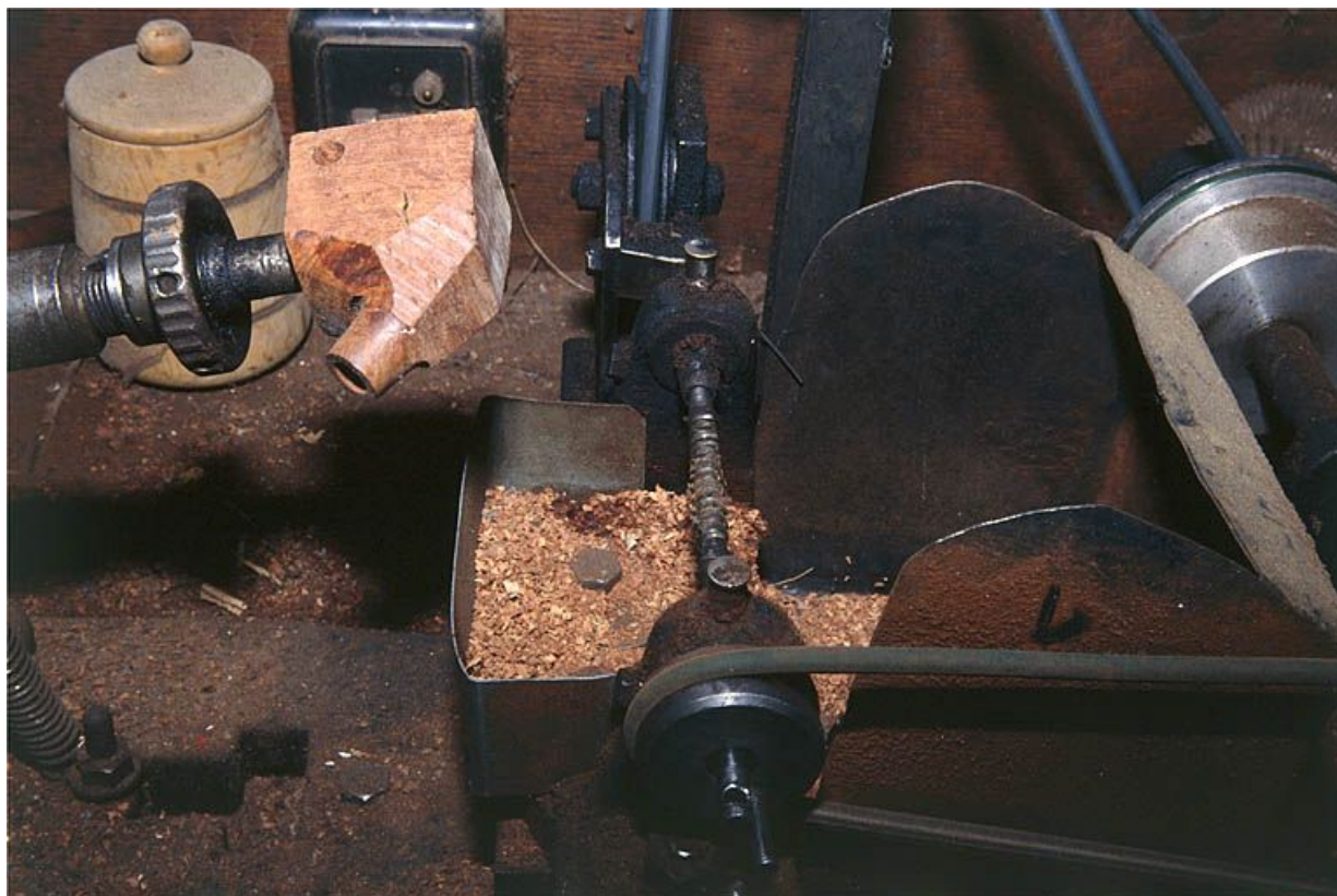
Partie gauche : détail du support de l'ébauchon. A droite, arbre cranté horizontal faisant office de fraise. 39, Saint-Claude, lieudit : Etables
