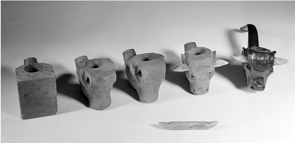
Pipe sculptée en forme de tête de boeuf, à divers stades d'achèvement. La sculpture s'effectue à main levée et à l'aide de la machine à sculpter de l'atelier de montage et de finition.
