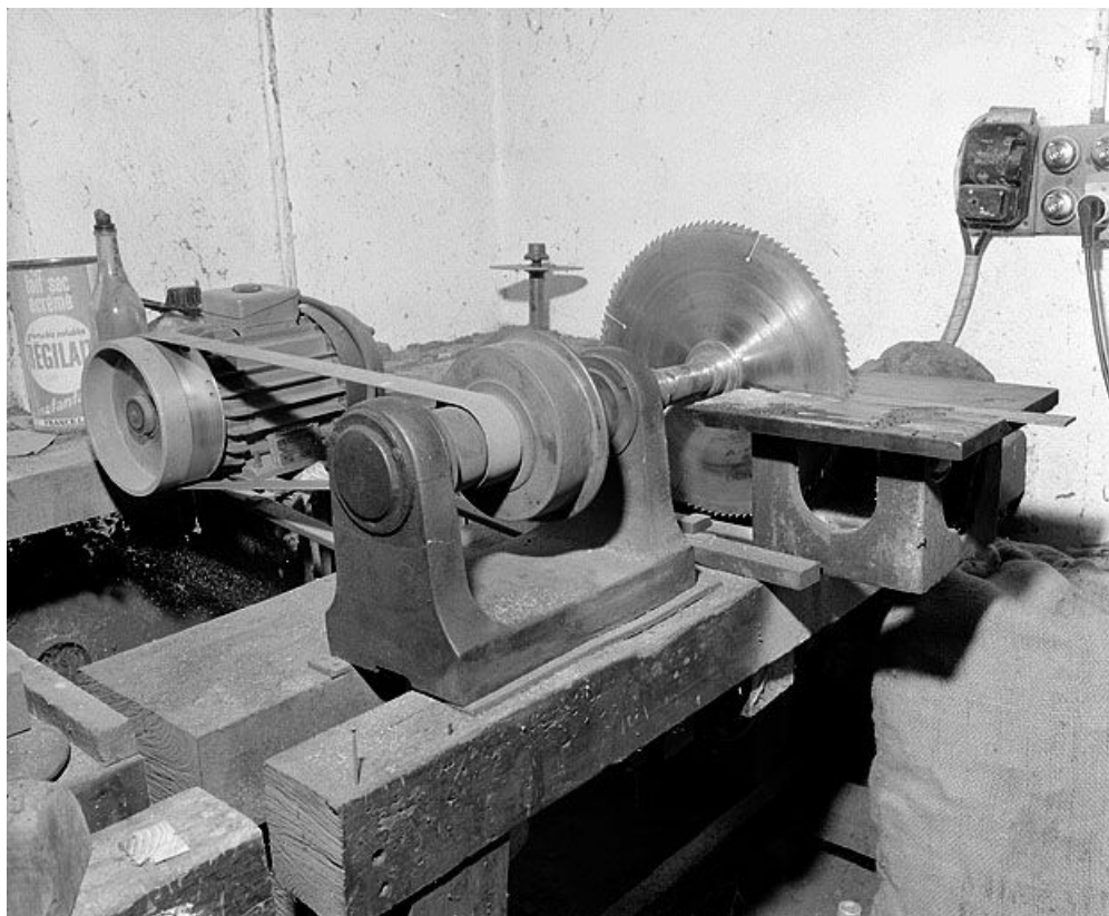
Vue d'ensemble de la scie de droite, servant au franchissage (mise à longueur).
