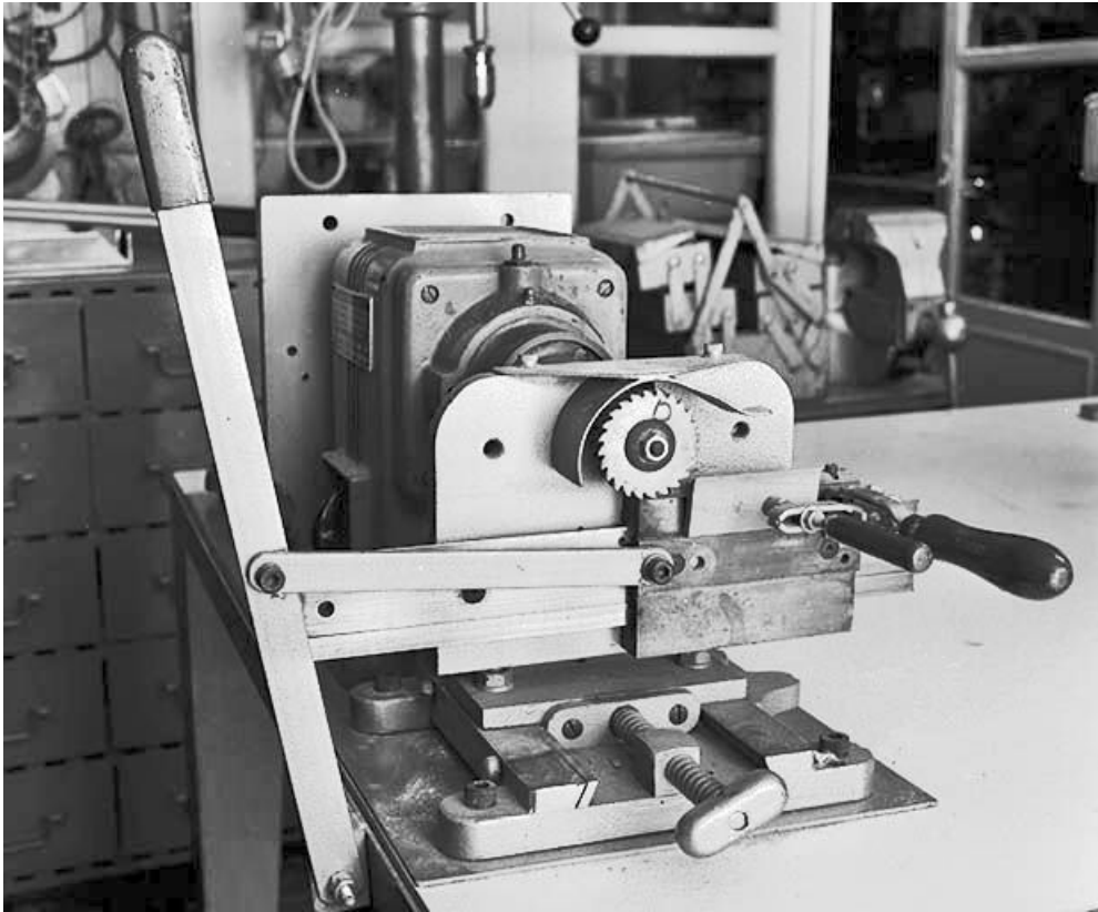
Détail de la fraise (côté fraiseuse).
