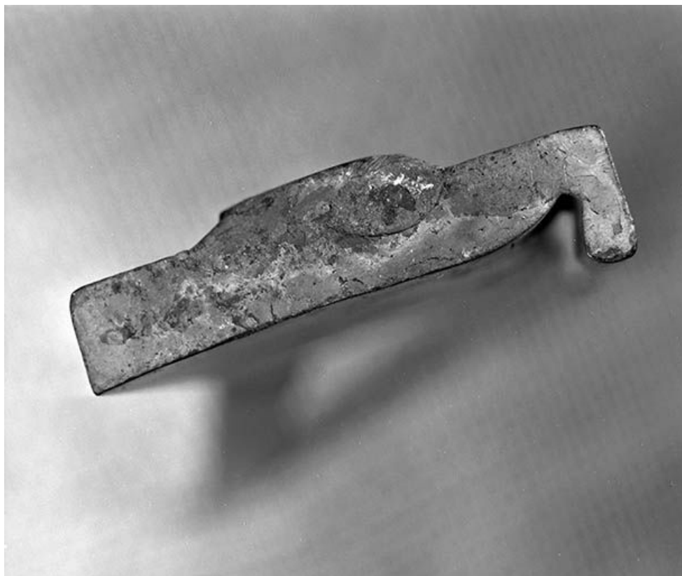
Profil d'un fer de forme servant à l'incrustation des motifs décoratifs sur le couvercle des tabatières.
