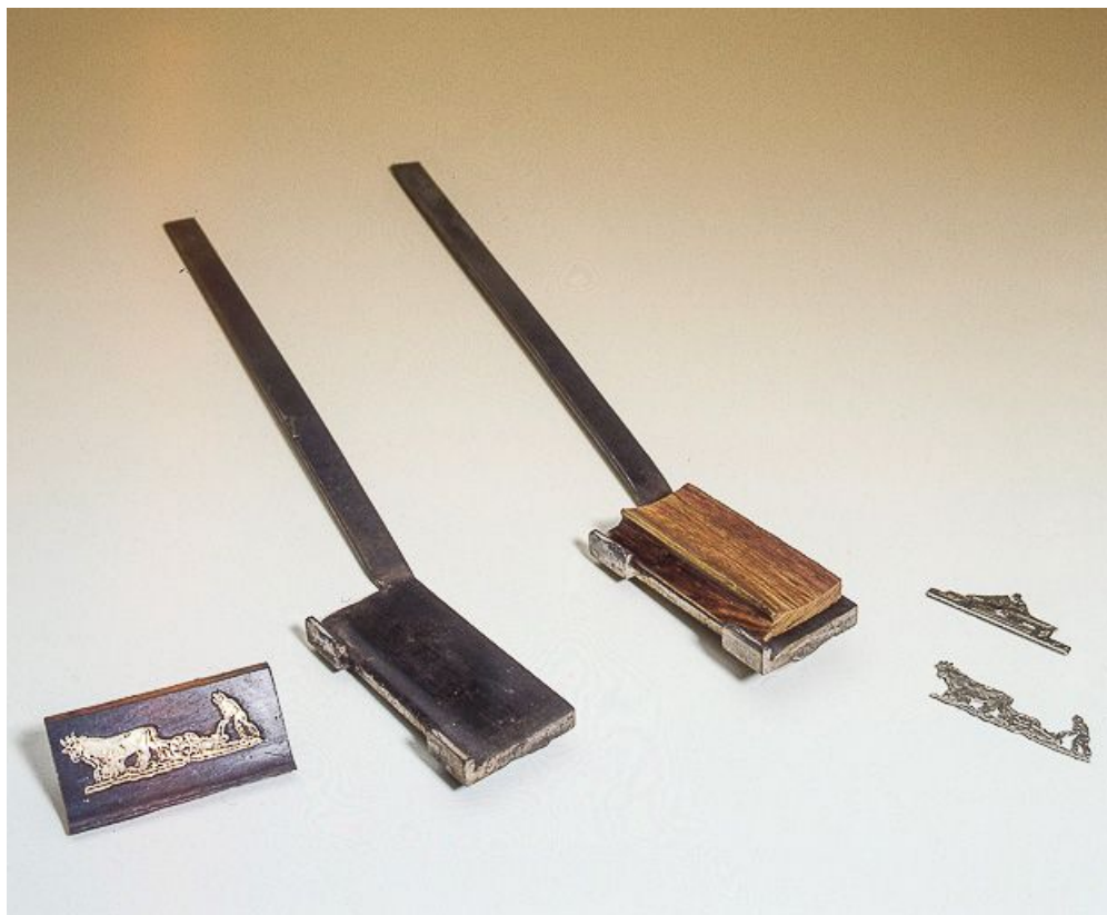
Couvercle de tabatière avec motif incrusté, fers de forme servant à l'incrustation et motifs décoratifs en maillechort.
