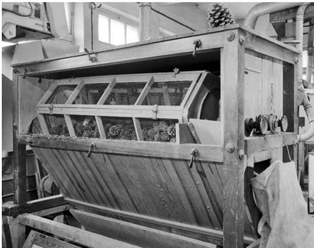
Détail du tambour chargé de cônes.
