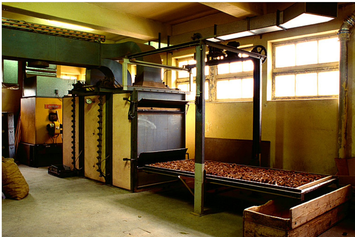
De gauche à droite : chaudière, séchoir et grille chargée de cônes sur le portique. 39, Supt, lieudit : la Joux
