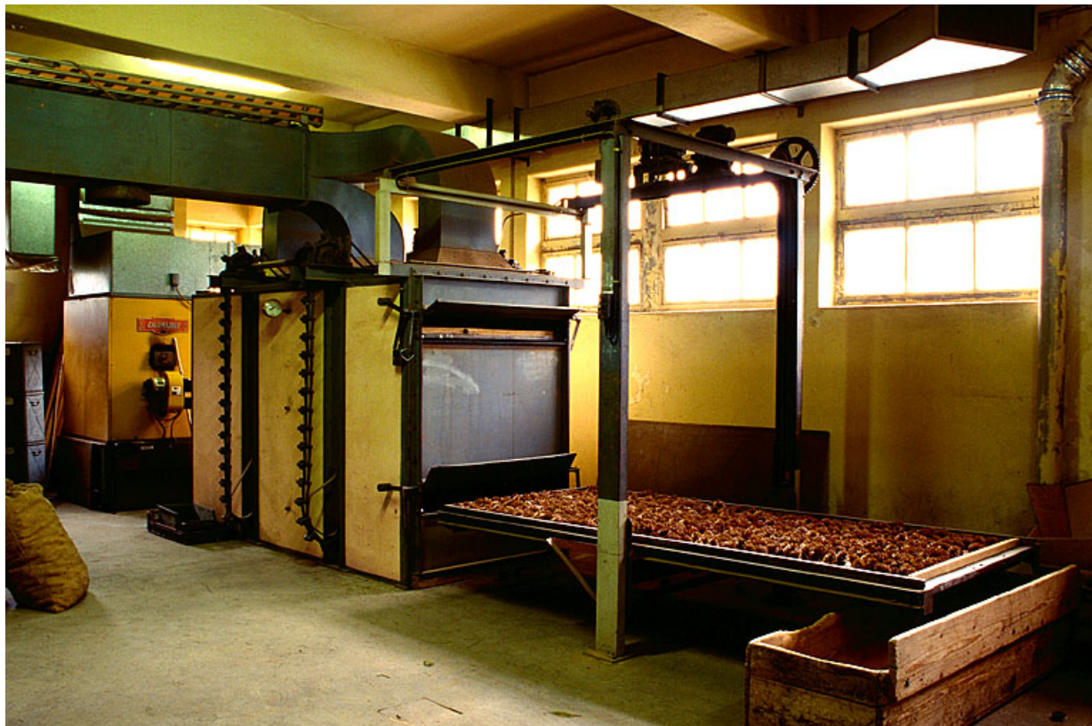
De gauche à droite : chaudière, séchoir et grille chargée de cônes sur le portique.
