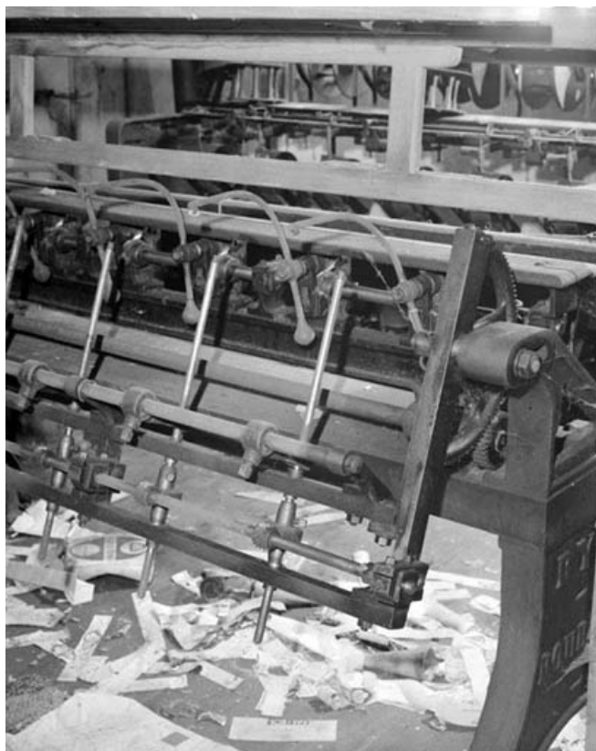
Détail montrant 3 broches et leurs ailettes (tiges recourbées). 39, Balanod, lieudit : sous Roches
