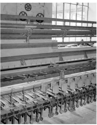
Détail du module de gauche, vu de trois quarts. De bas en haut, système de freinage des broches au pied, broches et leur courrois d'entrainement, système de guidage des fils et moulins.
