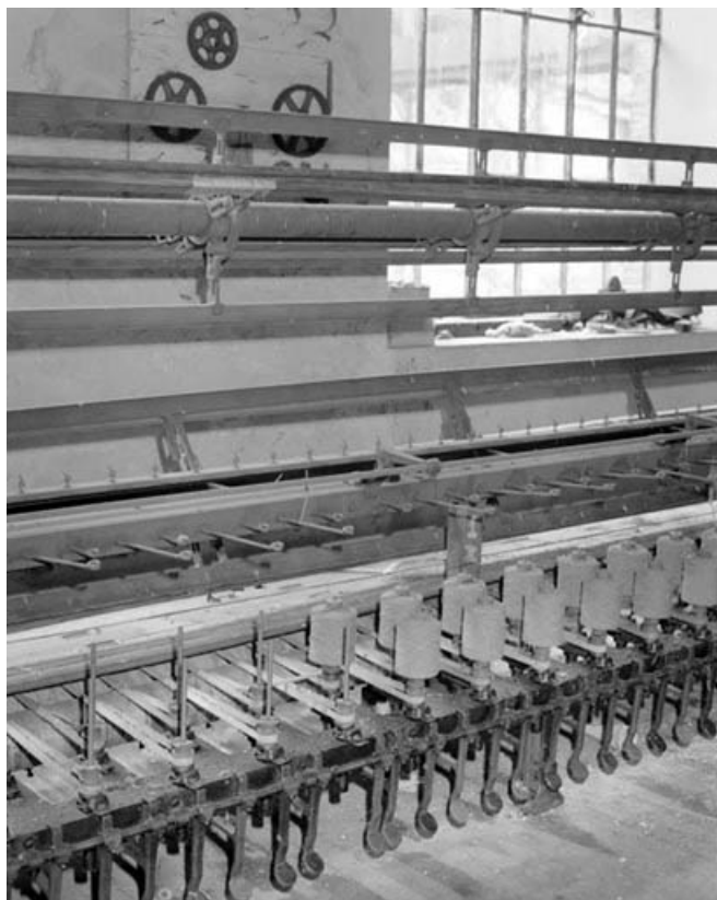
Détail du module de gauche, vu de trois quarts. De bas en haut, système de freinage des broches au pied, broches et leur courrois d'entraînement, système de guidage des fils et moulins.
