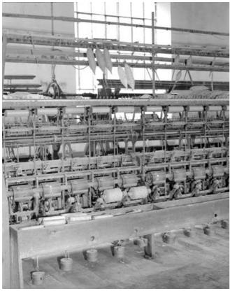
Détail d'une face vue de trois quarts, montrant 7 bobinots.De haut en bas, ratelier de dévidage à 2 niveaux supportant les bobines, tendeur, système de casse-fil, système de croisement des fils sur le bobinot, tambour moteur et bobinot.
