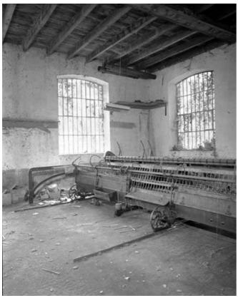
Chariot du module de gauche. Au premier plan, rail de guidage du chariot. Le volet ouvert laisse apparaître le système d'entrainement des broches.
