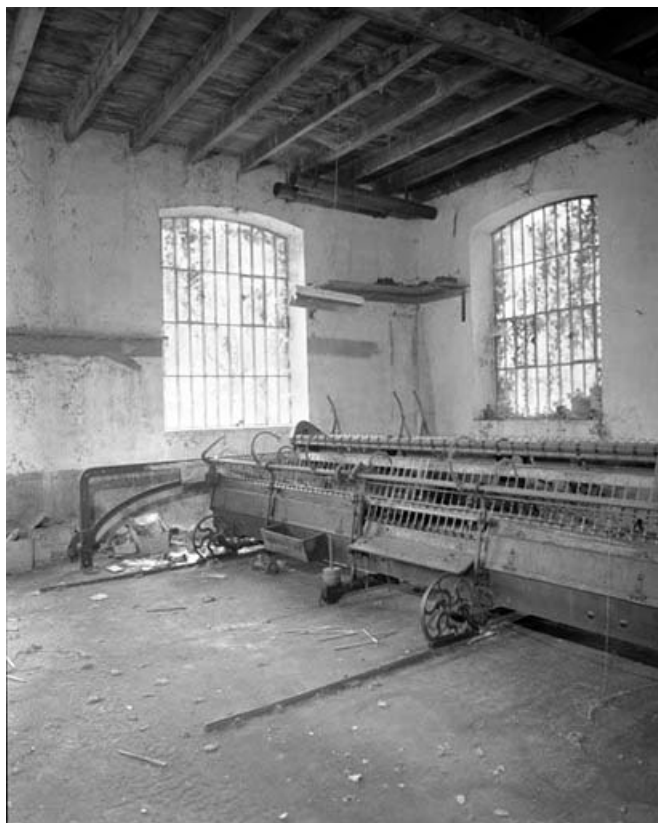
Chariot du module de gauche. Au premier plan, rail de guidage du chariot. Le volet ouvert laisse apparaître le système d'entraînement des broches.
