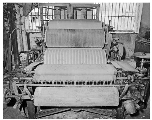
$\textbf{Face arri\`ere.} \textbf{Rouleau en bois, guide-fils, manchons frotteurs, cylindre volant et cylindres travailleurs.}$
