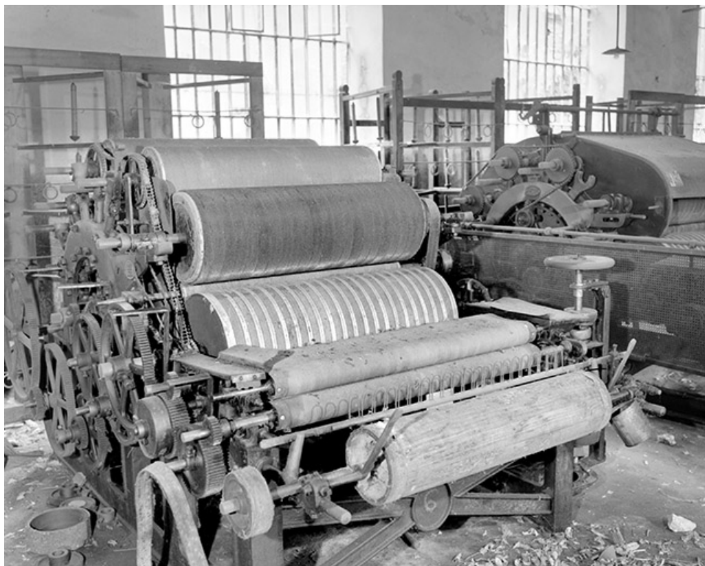
Face arrière vue de trois quarts gauche. Rouleau en bois, guide-fils, manchons frotteurs, cylindre volant et cylindres travailleurs. 39, Balanod, lieudit : sous Roches
