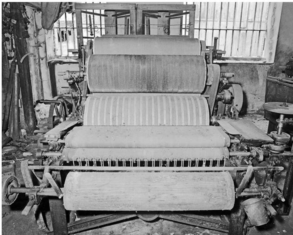
Face arrière. Rouleau en bois, guide-fils, manchons frotteurs, cylindre volant et cylindres travailleurs. 39, Balanod, lieudit : sous Roches
