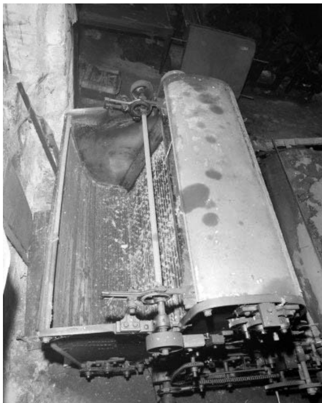
Chargeur peseur : intérieur du bac.
