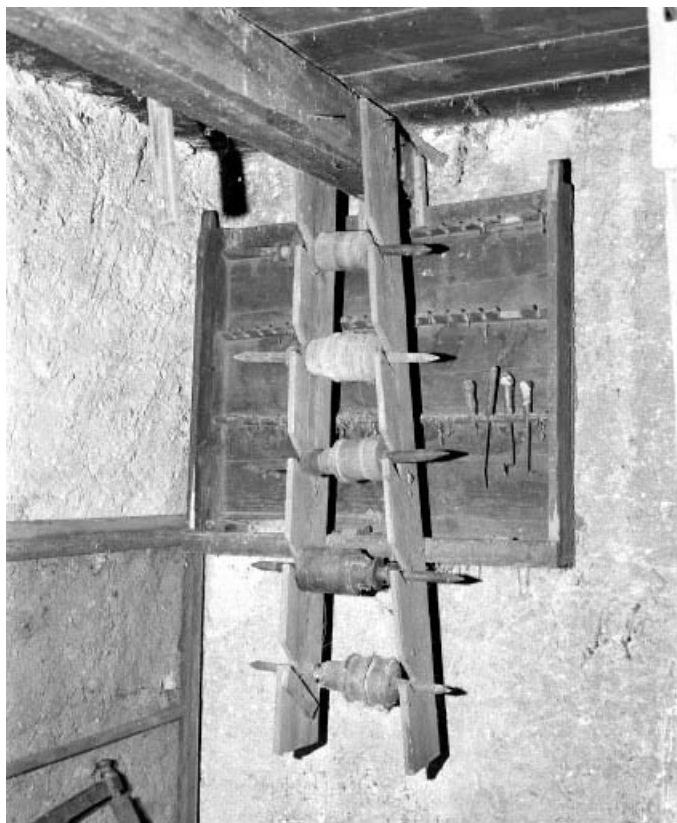
Rateliers. Le ratelier du second plan accueille les outils du tourneur, celui du premier plan (portant des axes) semble ne pas avoir de lien avec le tour.
