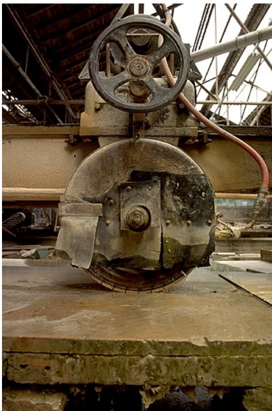
Débiteuse nord : détail de l'organe de sciage.
