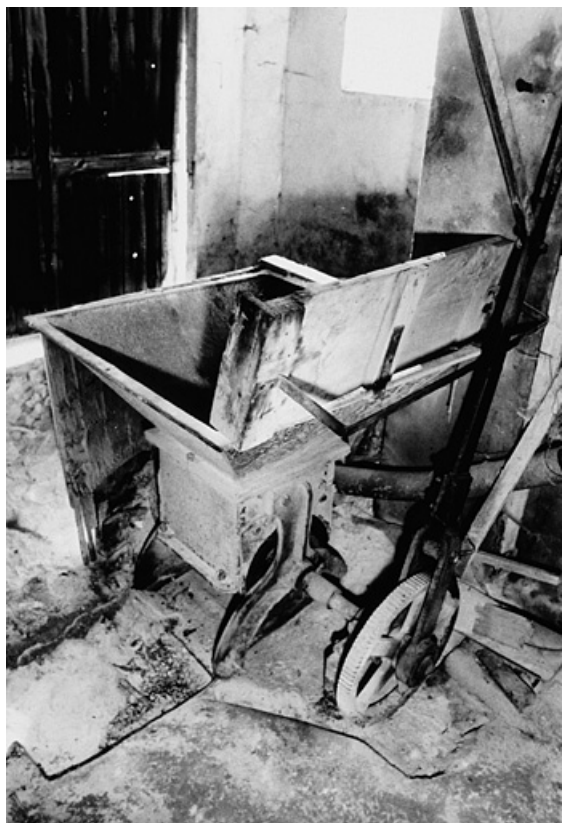
Doseur de sable, vu en plongée.
