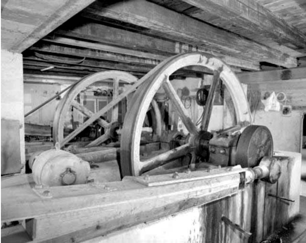
Système d'entraînement : côté moteur. Moteur, volant, manivelle et bielle.
