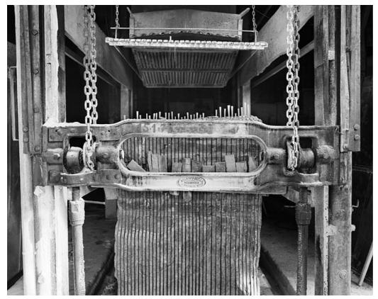
Guide support du châssis porte-lames d'une scie Décamps.
