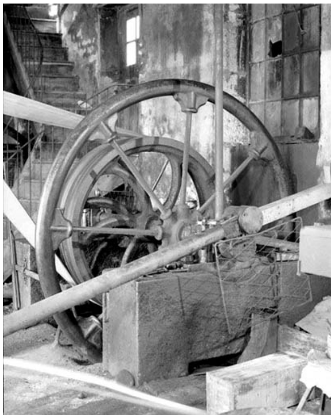
Système d'entraînement : volant d'inertie.
