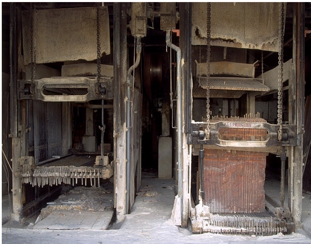
Deux châssis de scie multilames Décamps.
