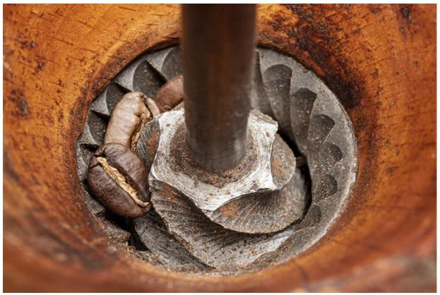
Moulin fabriqué à Valentigney. Mécanisme de broyage.
