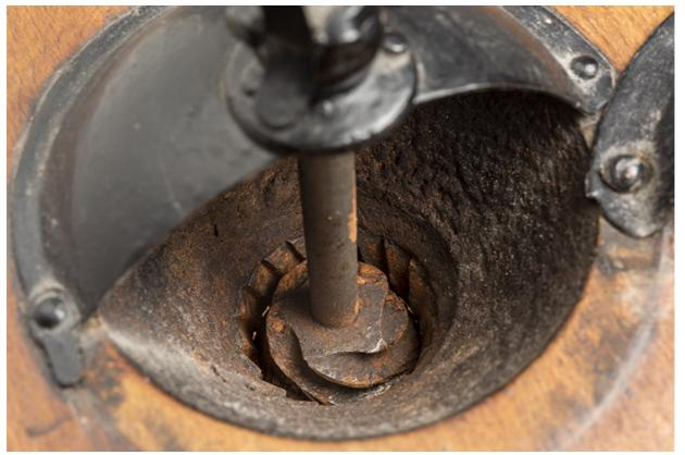
Moulin fabriqué à Pont-de-Roide. Mécanisme de broyage.
