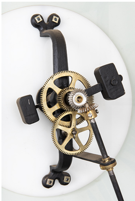
Cadran : système de renvoi et commande des aiguilles (au verso). 25, Mamirolle, 10 rue des Quatre Vents
