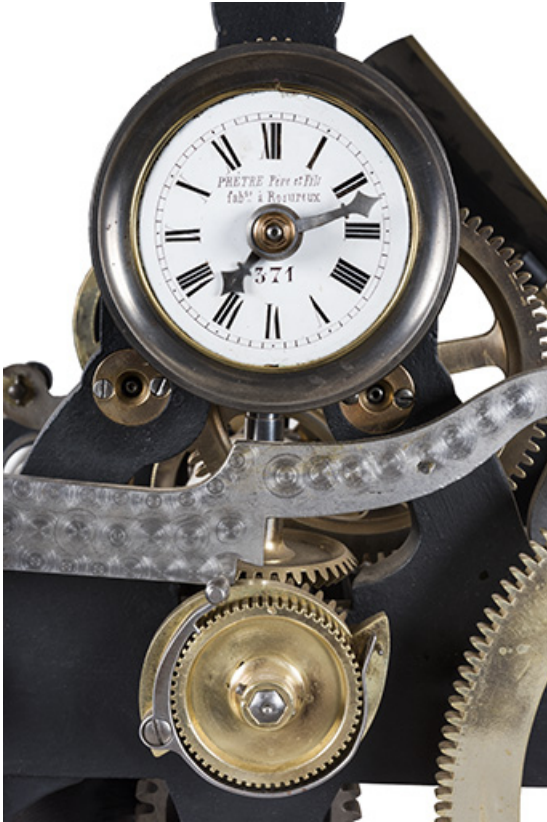
Mouvement, mécanisme des heures : cadran de contrôle et roue dentée. 25, Mamirolle, 10 rue des Quatre Vents
