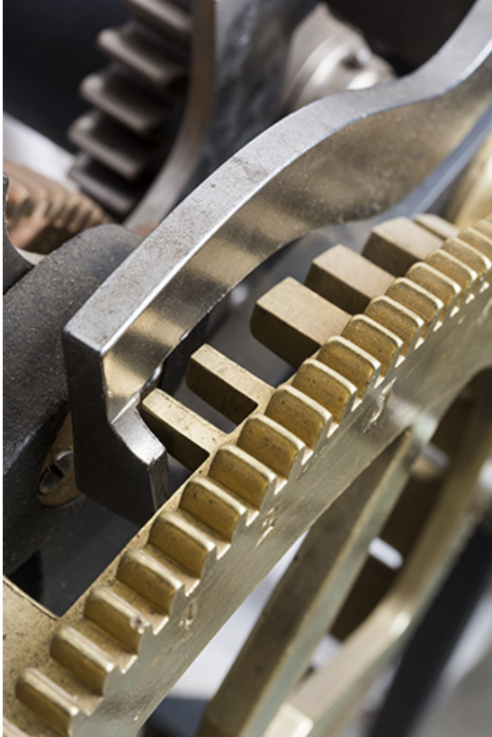
Mouvement, mécanisme des sonneries : système de la roue de compte. 25, Mamirolle, 10 rue des Quatre Vents
