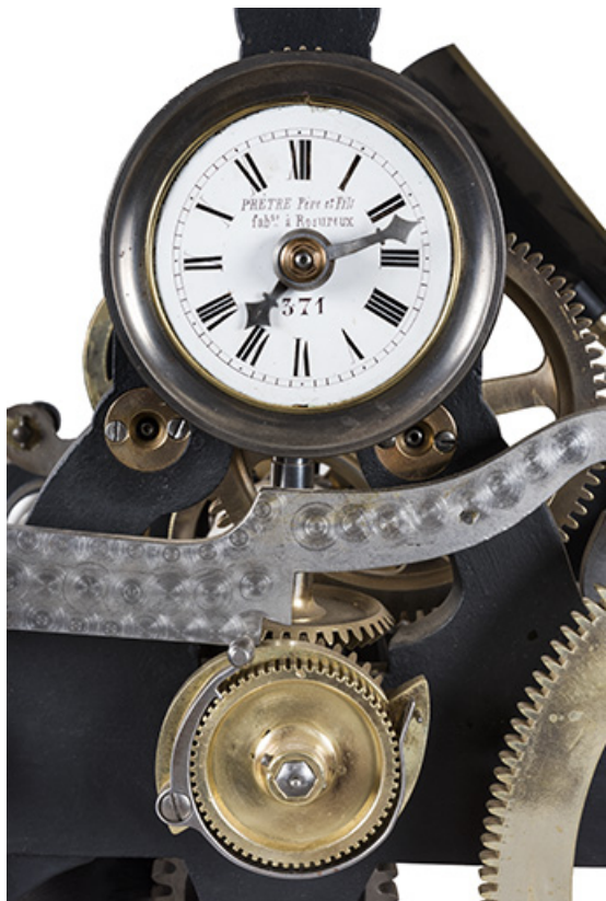
Mouvement, mécanisme des heures : cadran de contrôle et roue dentée.
