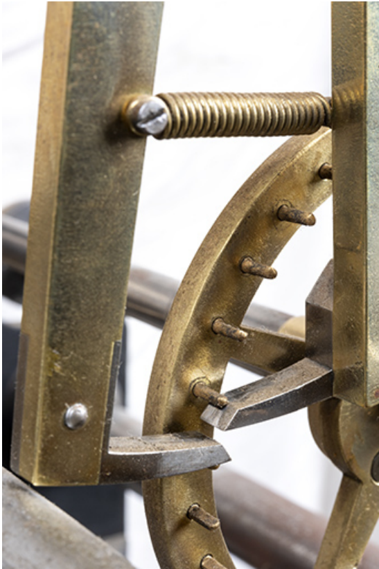
Mouvement, mécanisme des heures : échappement à chevilles (détail de l'ancre et des chevilles). 25, Mamirolle, 10 rue des Quatre Vents
