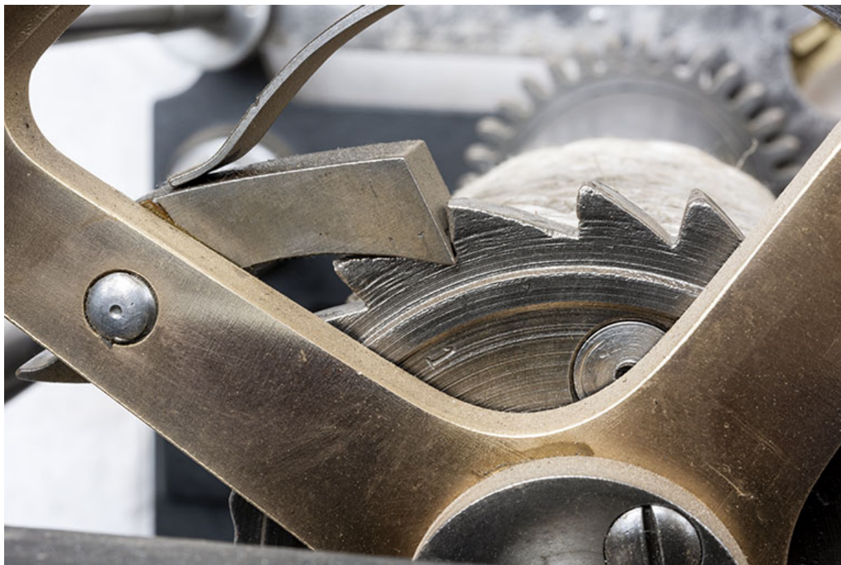
Mouvement, mécanisme des sonneries : détail du cliquet.
