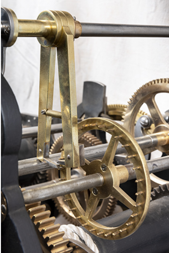
Mouvement, mécanisme des heures : échappement à chevilles. 25, Mamirolle, 10 rue des Quatre Vents
