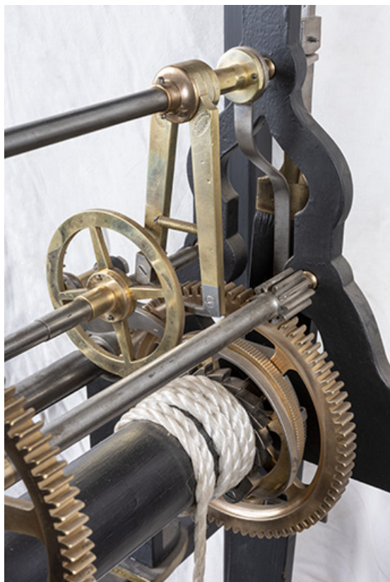
Mouvement, mécanisme des heures : échappement à chevilles et tambour moteur. 25, Mamirolle, 10 rue des Quatre Vents
