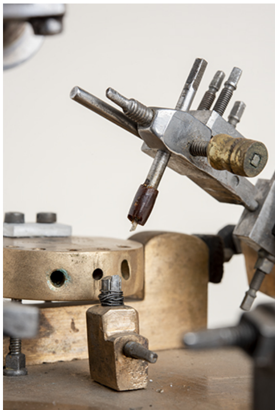
Tasseau (à gauche) et lime sur son support.
