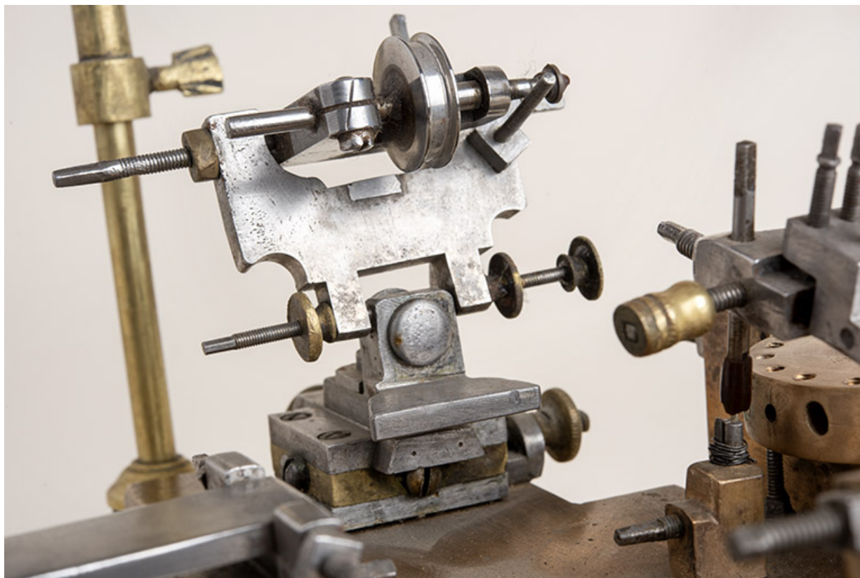
Support de la meule en saphir (à droite), avec sa poulie motrice.
