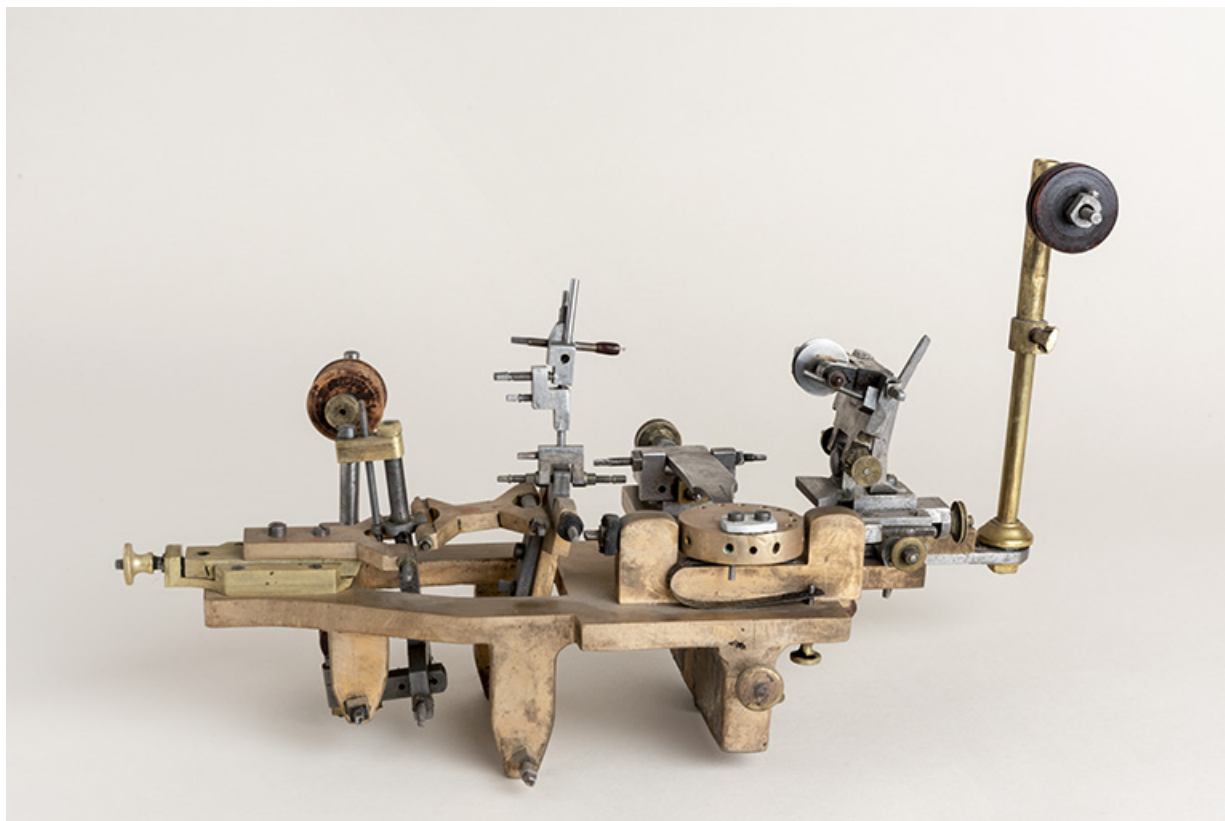
Vue de face, côté tasseau. Lime (au centre) et meule (à droite) sont levées.
