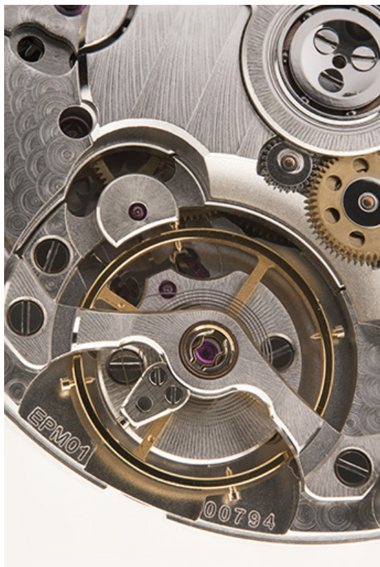
Face côté fond : balancier-spiral (vue rapprochée). 25, Morteau, 1 rue du Bief
