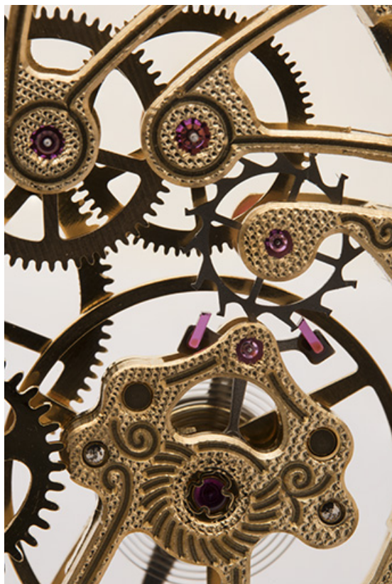
Détail : échappement à ancre (avec le coq au premier plan). 25, Villers-le-Lac, 4 place Saint-Jean
