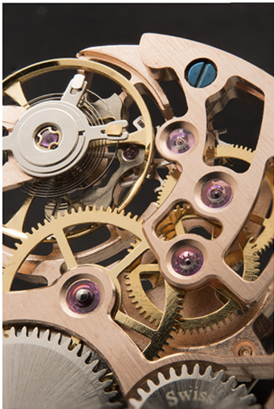
Mouvement rose, détail côté fond : amortisseur de chocs et rouage. 25, Villers-le-Lac, 4 place Saint-Jean
