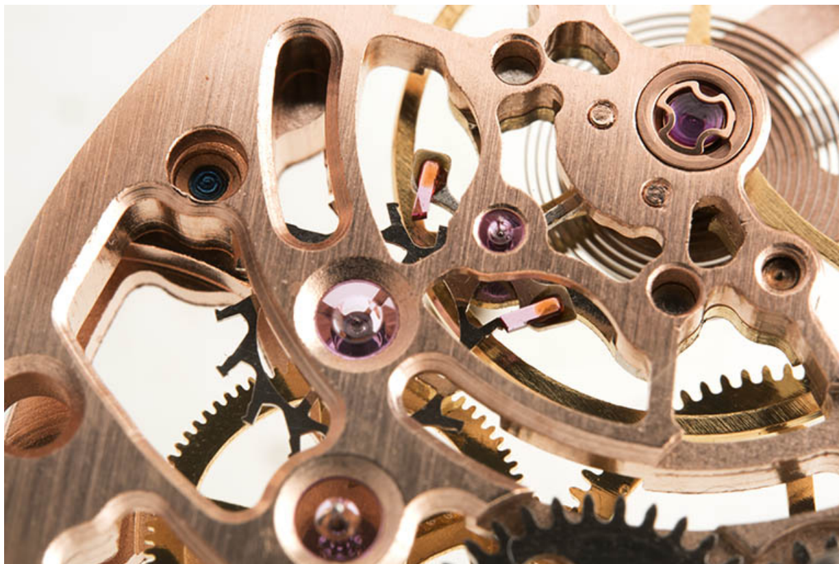
Mouvement rose, détail côté cadran : rubis et amortisseur de chocs. 25, Villers-le-Lac, 4 place Saint-Jean
