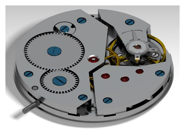
Montre de gousset mécanique : mouvement côté fond.
