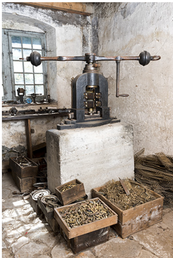
Vue d'ensemble (cadrage vertical). Les caisses au premier plan contiennent des pièces découpées (outils à centrer) et des déchets de découpe.
