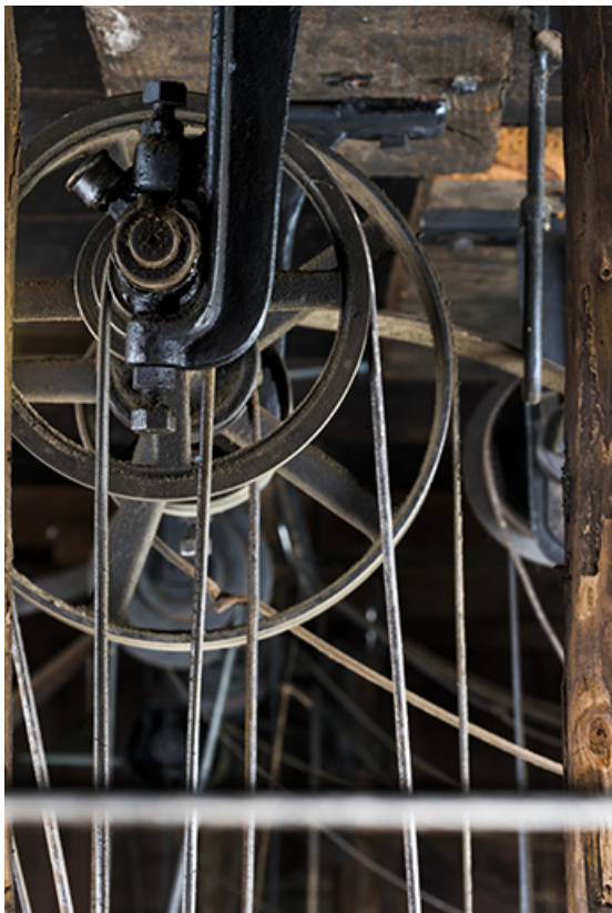
Détail de transmission : chaise col de cygne avec graisseur. 25, Les Gras
