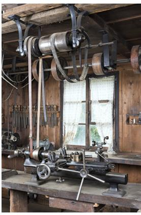
Exemple de disposition : tour revolver (rangée centrale). Même système que la machine à décolleter : le levier vertical au plafond (à droite) permet de changer de poulie la courroie motrice de l'arbre secondaire tandis qu'une deuxième courroie transmet l'énergie au tour, équipé d'une poulie étagée.
