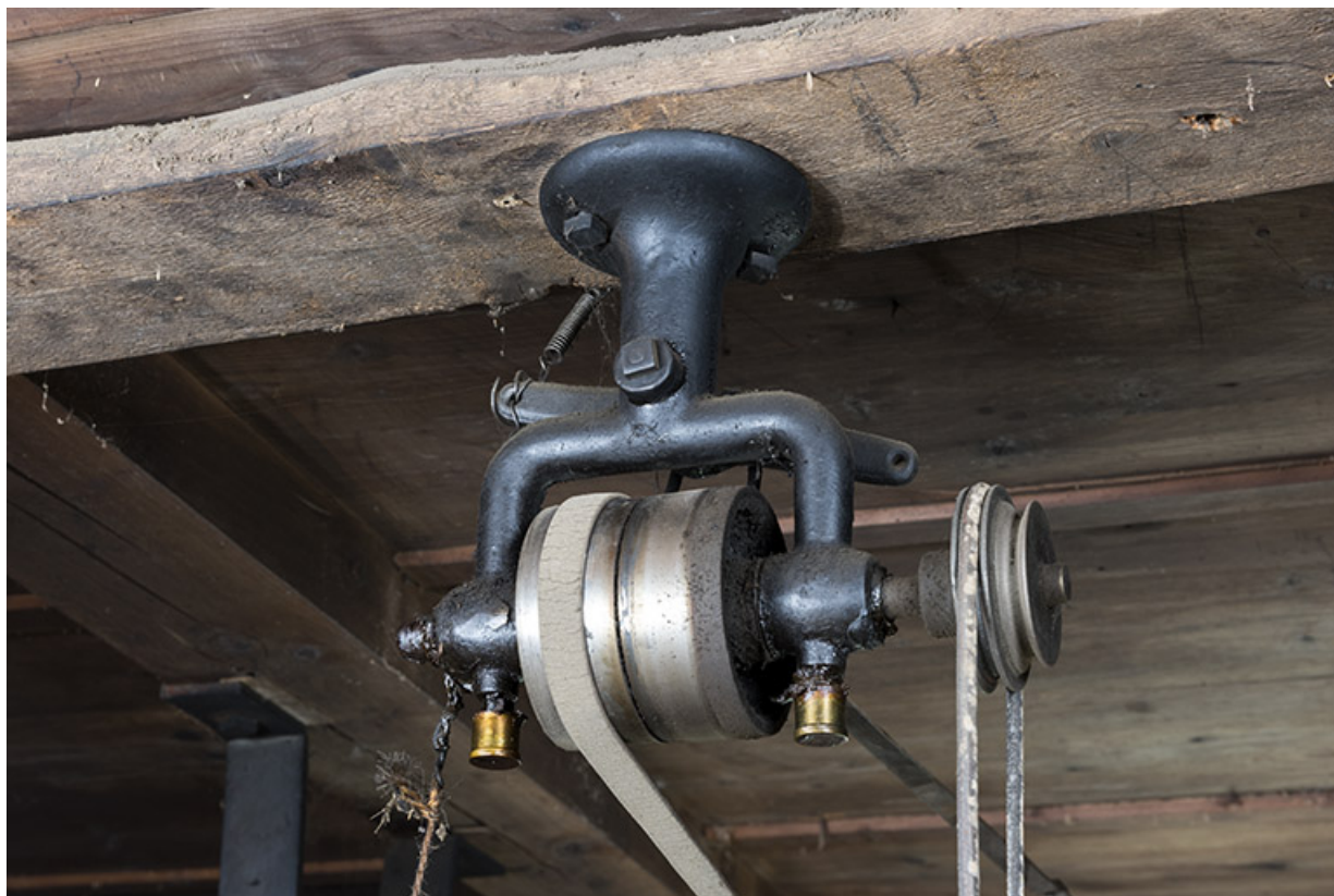
Renvoi de mouvement à deux graisseurs. La fourchette, commandée par la corde à gauche, se devine à l'arrière-plan. 25, Les Gras
