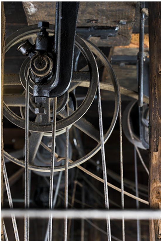
Détail de transmission : chaise col de cygne avec graisseur.
