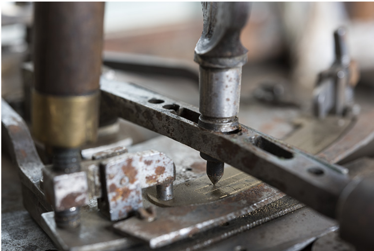
Module de gravage : la pointe à graver.
