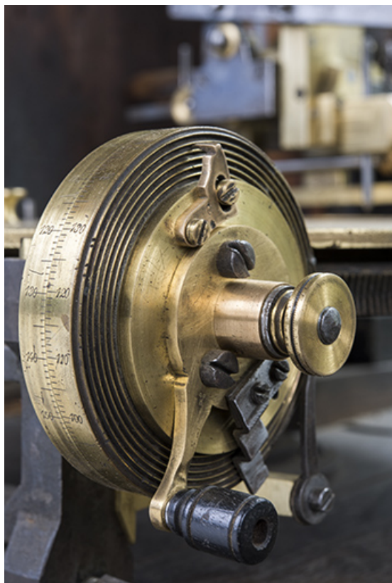
Plateau diviseur : manette et disques gradués du système de mise en rotation. 25, Les Gras
