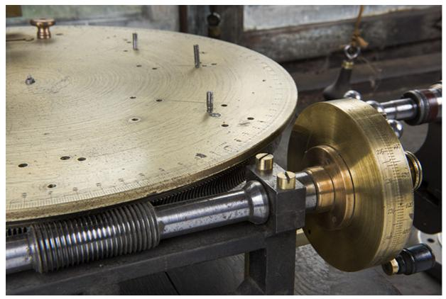
Plateau diviseur : système de mise en rotation.
