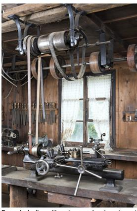
Exemple de disposition : tour revolver (rangée centrale). Même système que la machine à décolleter : le levier vertical au plafond (à droite) permet de changer de poulie la courroie motrice de l'arbre secondaire tandis qu'une deuxième courroie transmet l'énergie au tour, équipé d'une poulie étagée.
