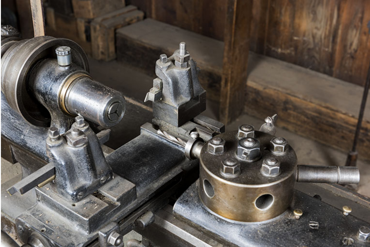
Partie travaillante : mandrin sur la poupée fixe à gauche, burins au centre et tourelle revolver à droite. 25, Les Gras
