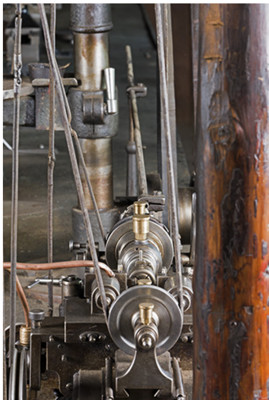
Vue de profil : poulie de l'outil au premier plan, du système d'entraînement au second plan. 25, Les Gras
