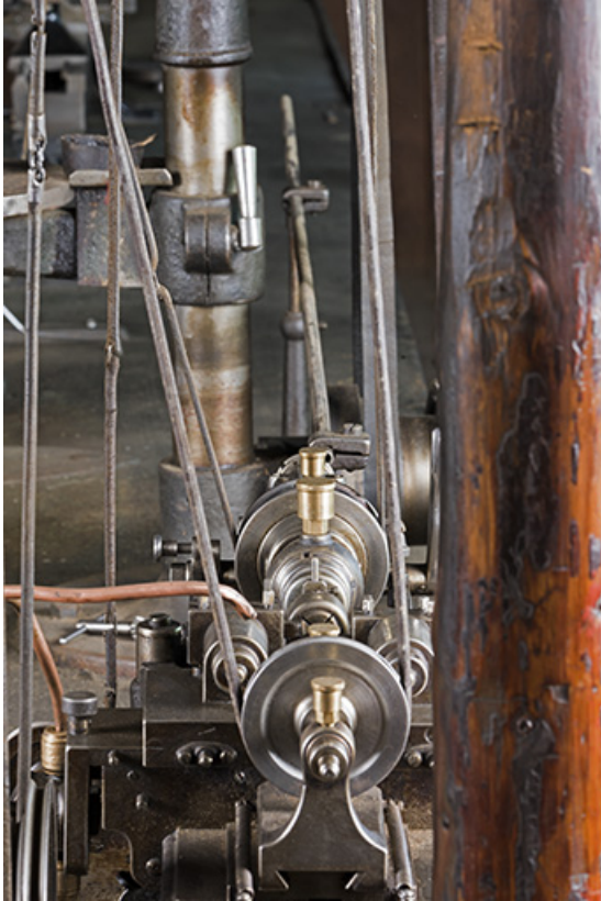
Vue de profil : poulie de l'outil au premier plan, du système d'entrainement au second plan. 25, Les Gras
